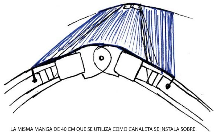
LA MISMA MANGA DE 40 CM QUE SE UTILIZA COMO CANALETA SE INSTALA SOBRE LAS CUBIERTAS Y SE ADHIERE AL PLÁSTICO CON LA HUMEDAD.
