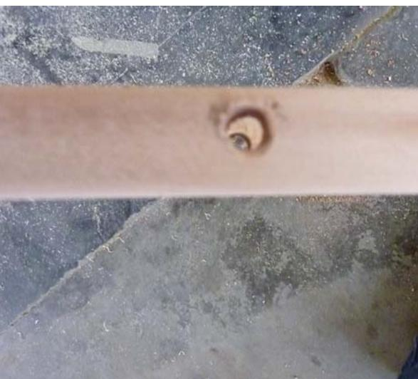
En el orificio de las puntas de los listones se ensambla el liston fijador con un tarugo, de la misma forma que las piezas interiores.
