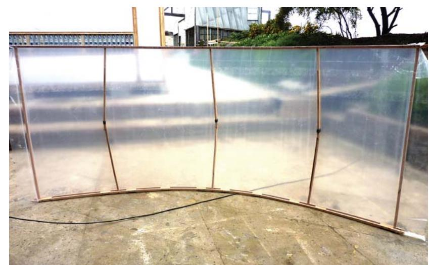
Las piezas de pivote interiores tienden a flexionarse pero se mantiene la tensión del polietileno.
