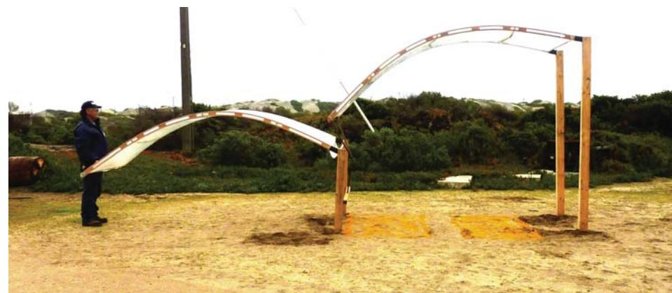
Se muestra en la foto que en el caso de que se levantara la segunda cubierta no afectaría a la primera cubierta.
