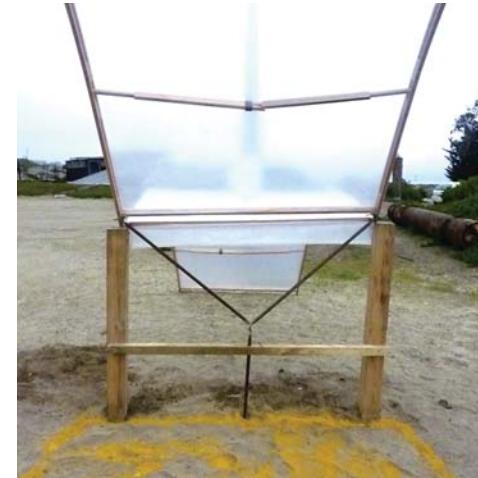
La pieza de fierro sirve para levantar una sola cubierta.
