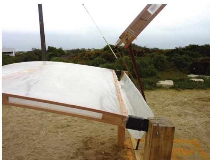
La cubierta se levanta hasta 40 cm para la ventilación y el agua de lluvia cae en la canaleta.
