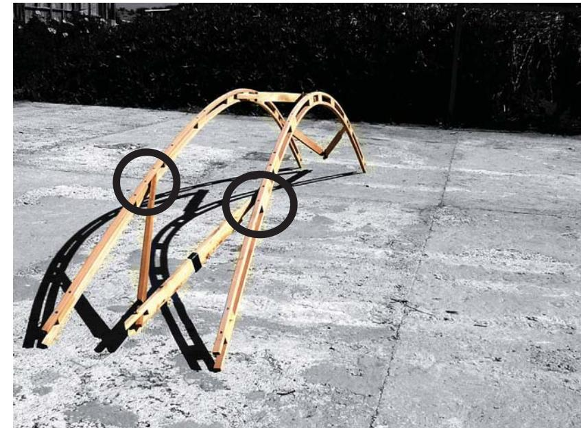
EL CORTE DE LOS EXTREMOS ES PARA QUE LA FIGURA SE REDUZCA Y PUEDA GIRAR EN 360°
