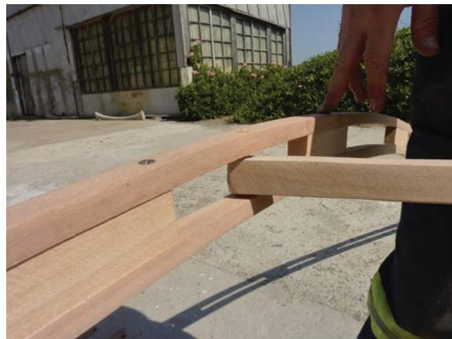
SE OBSERVA LA UNION DE LA PIEZA CON LA VIGAS CENTRAL, DEBE TENER ESA MEDIDA PARA POSICIONARSE DENTRO DEL ANCHO DE LA VIGA.
