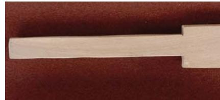
PARTE DE LOS EXTREMOS DE LA PIEZA PIVOTE, ESTA PARTE ES LA QUE VA LIGADA A A LA VIGA Y ESTA CORTADA DE 2.5 CM PARA QUE CALZE DENTRO DEL ANCHO DE LOS LISTONES Y TIENE 20 CM DE CORTE PARA QUE PUEDA REDUCIR SU TAMAÑO EN EL MOMENTO DE ESTAR LIGADO A LOS ARCOS.(PERMITTE UN MAYOR MOVIMIENTO)
