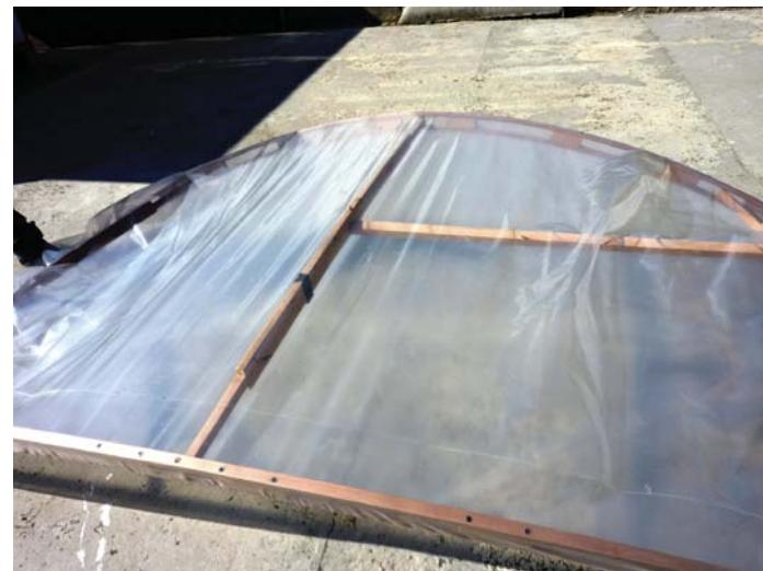
Se debe empujar con el liston hasta que la pieza interior este totalmente estirada
