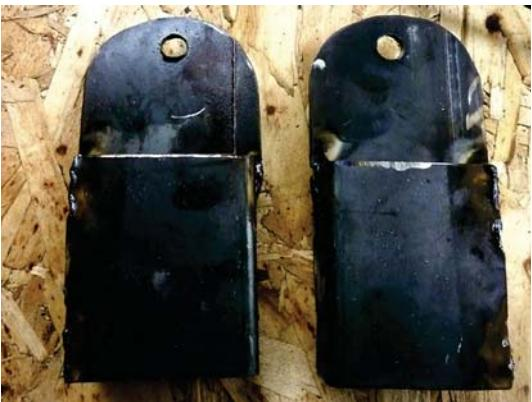
Se cortan con la galleta los perfiles de (6cmx2,2cm) se cortan en piezas de 6 cm. de ancho.luego las pletinas se cortan de 10 cm de largo.
