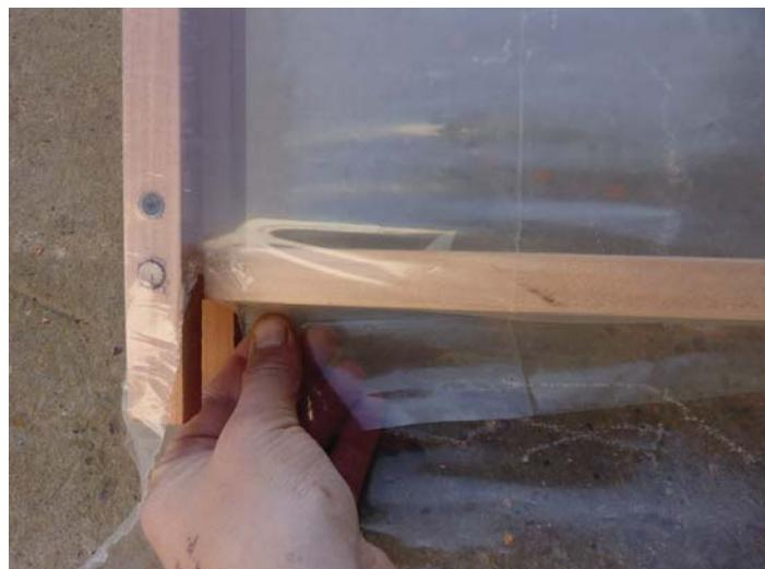
Luego el plástico se endereza y se corta en los lados para tensar la parte de arriba de la manga.
