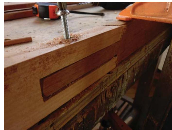
EL TRONILLO SE COLOCA EN EL ORIFICIO UNIENDO LAS PARTES.
