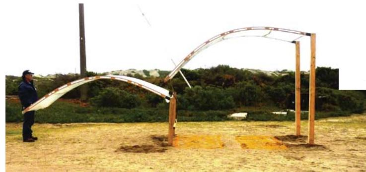
LA ABERTURA DE LAS CUBIERTAS PUEDE LLEGAR A LOS 40 CM. ESTA REGULADO POR LA PIEZA DE ABERTURA MANUAL. NO ES MUY BUENO QUE LA ABERTURA SEA MAYOR YA QUE APESAR QUE EL VIENTO DEL FONDO DE LAS QUEBRADAS ES MUY BAJO EN ALGUN CASO PUEDE LLEGAR AFECTAR SI LA ABERTURA ES MAYOR.
