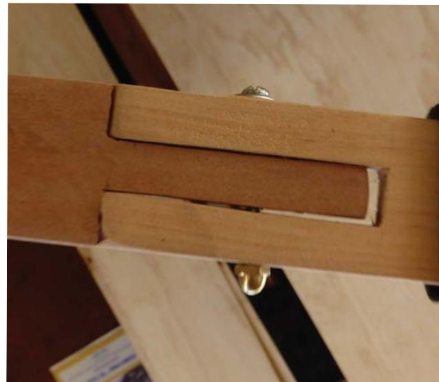
EL PERNO DEBE SER CON TUERCA CIEGA PARA NO DAÑAR EL POLIETILENO
