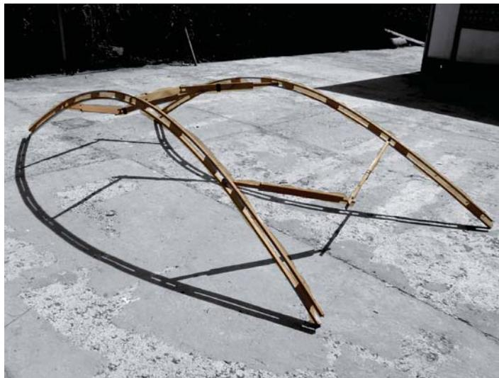
La viga armada con las piezas de pivote interior se extiende 1.48, y se flecta hasta 30 cm. En la foto se muestra extendida pero no en su máxima extensión.
