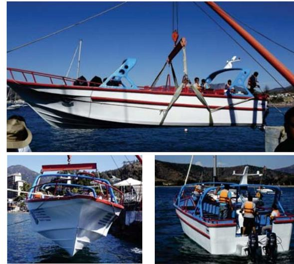
Figura 69. Fotografías de Embarcación de Papudo. Embarcación para 34 pasajeros de Papudo. 11,5 mts de eslora con dos motores fuera de borda de 50 HP de cuatro tiempos. Posee un casco que, desde la parte central hacia la popa, posee un casco plano. Mientras que hacia la proa el casco tiene forma de V.
