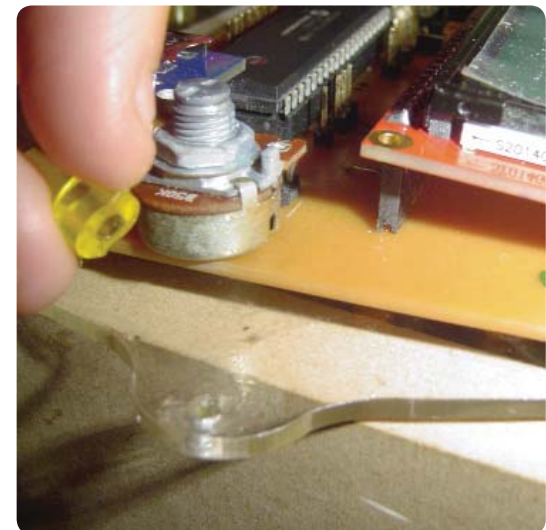
Se une la placa de programación a la base del chasis, se pone una pieza de goma para mantener la distancia entre la placa y la pieza acrílica, evitando que topen las soldaduras y se produzca calor
