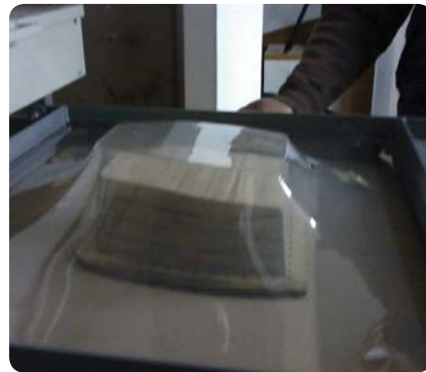
Prueba termoformado, máquina de termoformado. Material: PAL CLEAR. No se produce suficiente vacío.
