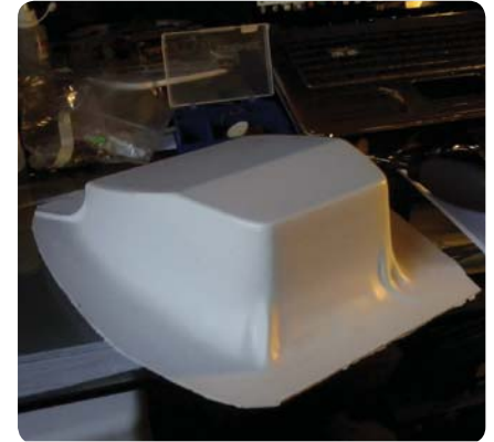
Termoformado e PAI, falta potencia al producir el vacío, no quedan finas las terminaciones
