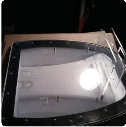
Chasis del modelo 5, para poner las placas de programación, cámara y baterías. En acrílico de 2 mm.
