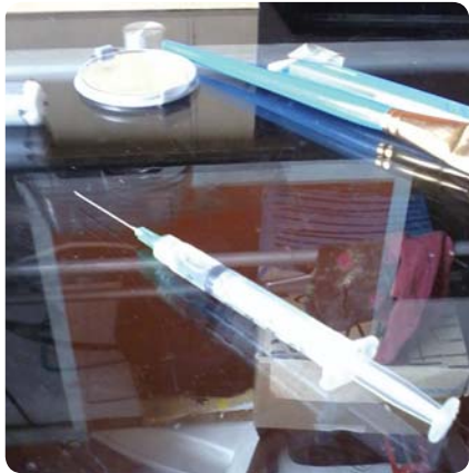
Cloroformo para uniones de laspiezas de acrílico de 2mm.
