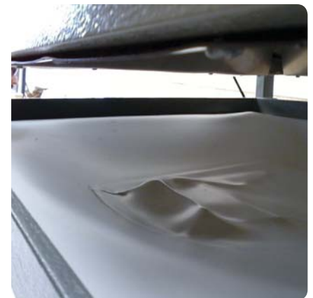
Termoformado e PAI, falta potencia al producir el vacío, no quedan finas las terminaciones
