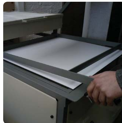
Termoformado e PAI, falta potencia al producir el vacío, no quedan finas las terminaciones
