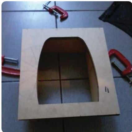
Molde y base para termoformar a presión.
