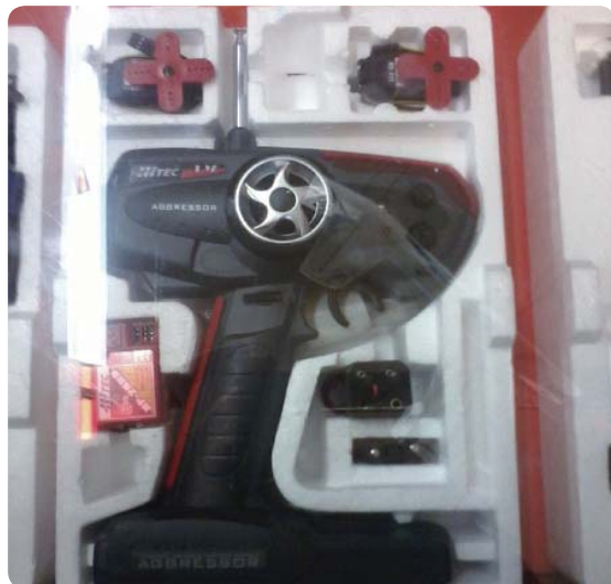
Pack de control remoto con receptor y dos servo motores, y set de pilas.
