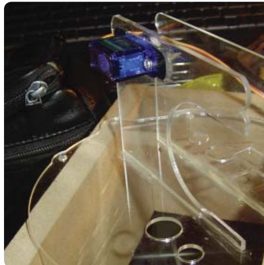
Se atornillan ambos lados del servo motor, fijando este elemento al chasis.
