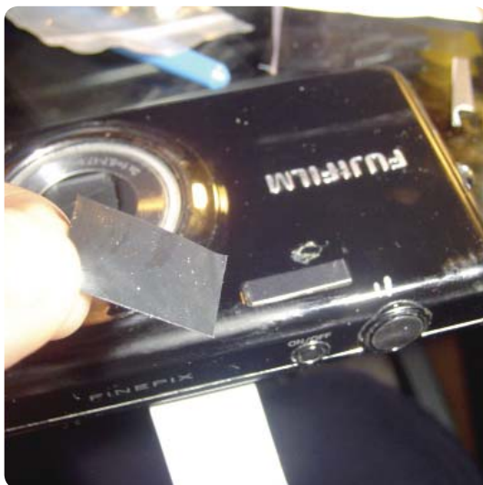
se tapa el flash de la cámara, para evitar el reflejo de luz al interior del objeto
