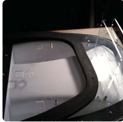
Chasis del modelo 5, para poner las placas de programación, cámara y baterías. En acrílico de 2 mm.
