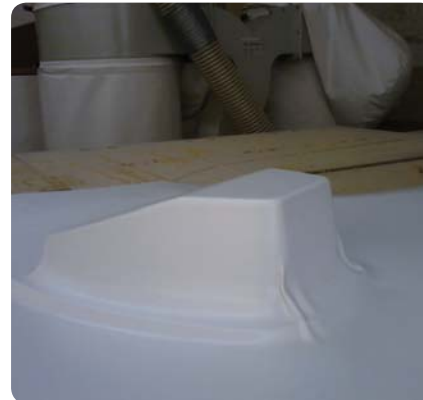
Termoformado e PAI, falta potencia al producir el vacío, no quedan finas las terminaciones
