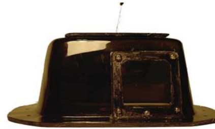
Casquete superior, vista frontal, con el policarbonato instalado.
