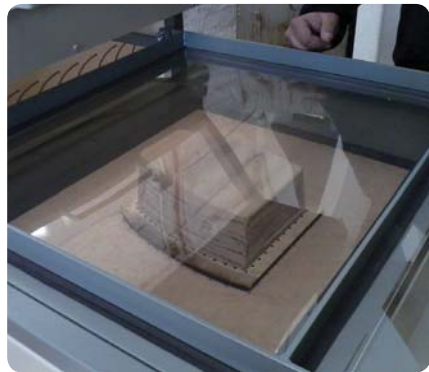
Prueba termoformado, máquina de termoformado. Material: PAL CLEAR. No se produce suficiente vacío.
