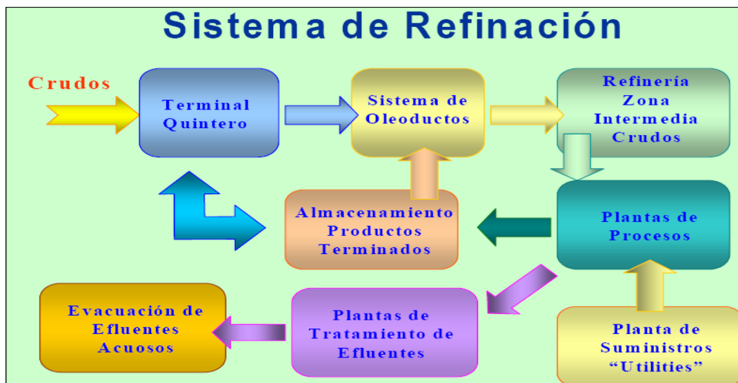
Figura N° 1 Sistema de Refinación
