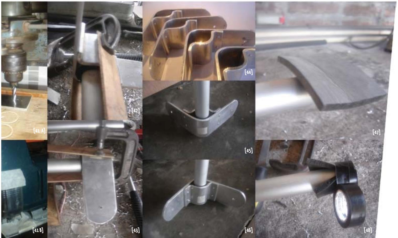
[34...35] Para doblar las piezas fijamos el trozo de aluminio con la matriz en el tornillo y luego de dejarlos firmes martillamos sobre un trozo de madera apoyado el aluminio, de modo que el aluminio comienza a tomar la forma de la curva, luego vamos cambiando de lugar la matriz con la pieza de aluminio y hacemos el resto de los dobleces por el mismo método.
