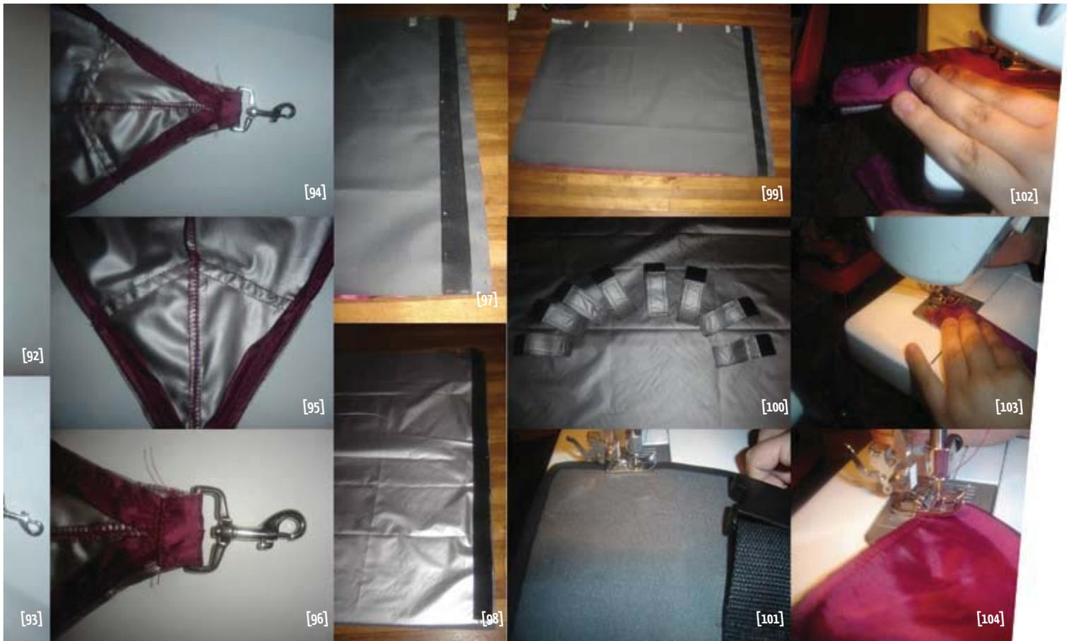
[85...91] Después de cortar los moldes, lo primero que se une son las piezas laterales, hasta lograr el friso lateral completo compuesto de cuatro de estas piezas [80], esto se realiza con la máquina de coser llamada overlock, ya que las costuras que realizan estas máquinas son más firmes y a la vez elásticas.
