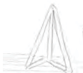
X2 pirámides laterales, para mejor distribución de cargas sobre la barra central, dan la altura al tensor.
