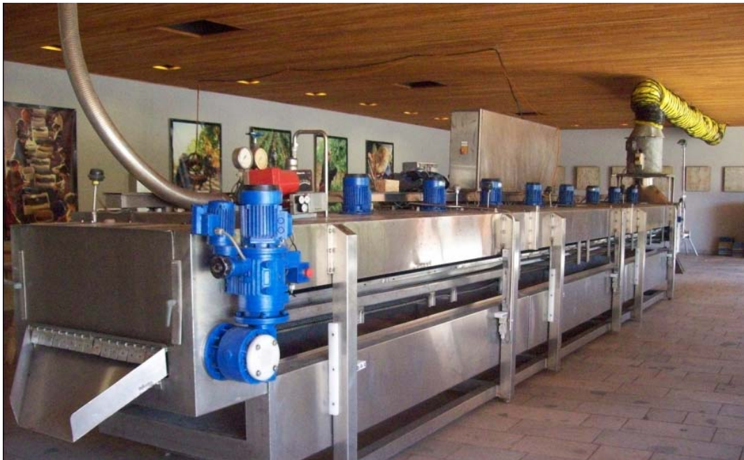
Figura Nº 13: Túnel criogénico continuo utilizado en la congelación de uvas en la viña Casa La Postolle.
