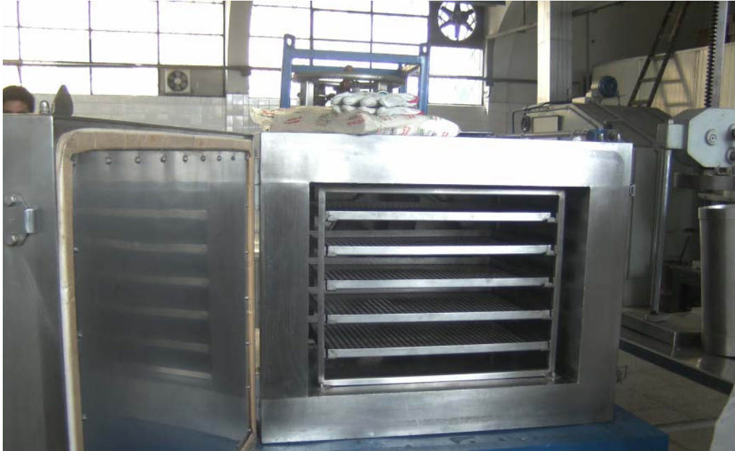
Figura Nº 10: Mini Labb, equipo similar al equipo Batch, de igual forma de trabajo pero de dimensiones menores.
