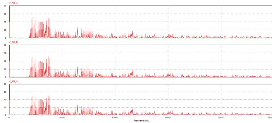
Figura 4-63 - Espectro de las tensiones de fase utilizando carga R-L en estrella
