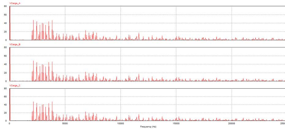
Figura 4-64 - Espectro de las tensiones en la carga (fase - neutro carga) utilizando carga R-L en estrella
