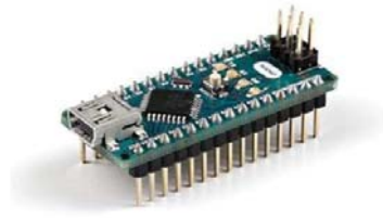
Figura 2-11: Placa de desarrollo Arduino Nano. (Fuente: arduino.cc )
