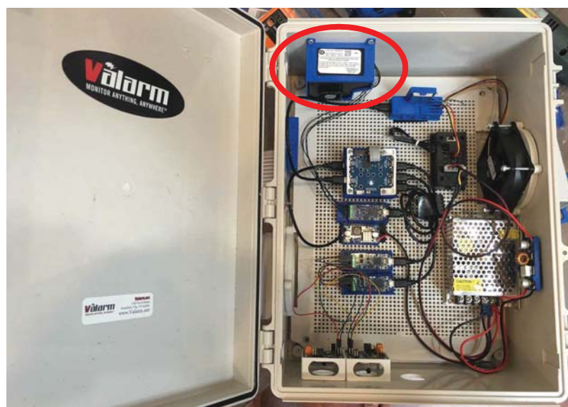
Figura A-A-4: Ubicación de sensor OPC-N2 en producto Valarm. (Fuente: Valarm)
