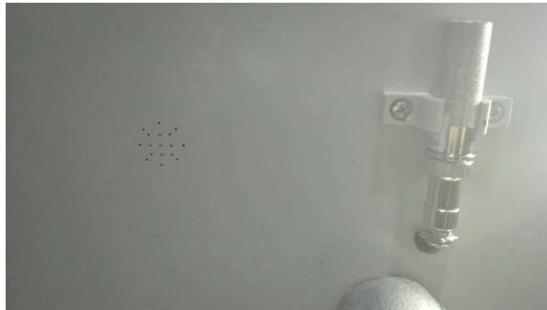
Figura 5-4: Ubicación sensor de temperatura y humedad, y perforaciones para sensor de presión.
