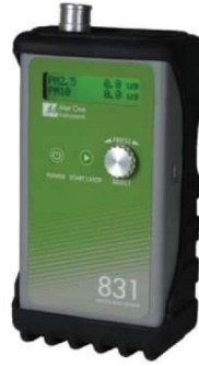
Figura 2-2: Sensor Aerosol Mass Monitor 831 (Fuente: Zefon).
