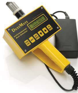
Figura 2-3: Sensor DustMate (Fuente: TechLab).
