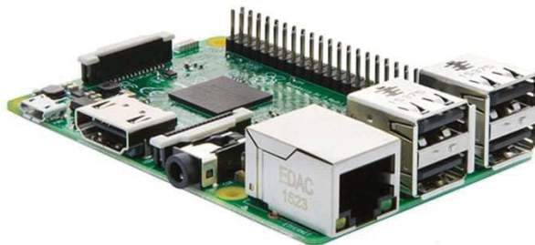
Figura 2-14: Computador embebido Raspberry pi 3. (Fuente: gearbest)
