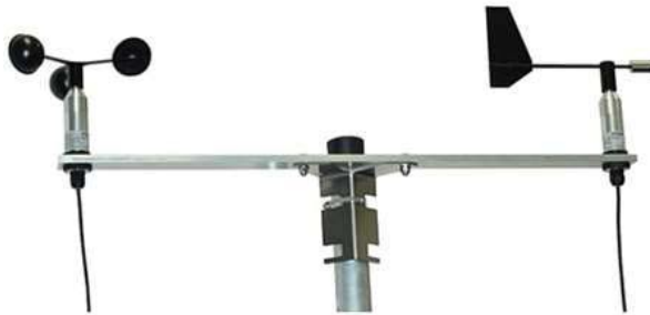
Figura 2-8: Sensor de velocidad y dirección del viento Vento. (Fuente: ADCON)
