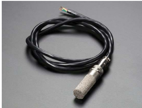
Figura 2-6: Sensor de temperatura y humedad SHT10. (Fuente: Olimex)
