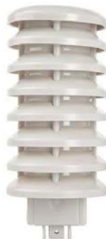
Figura A-A-1: Garita de platos meteorológica. (Fuente: MeteoStar)
