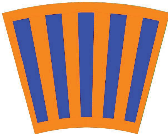
Figura 4-1: Jaula de ardilla, distribución de las barras en la matriz de cobre.
