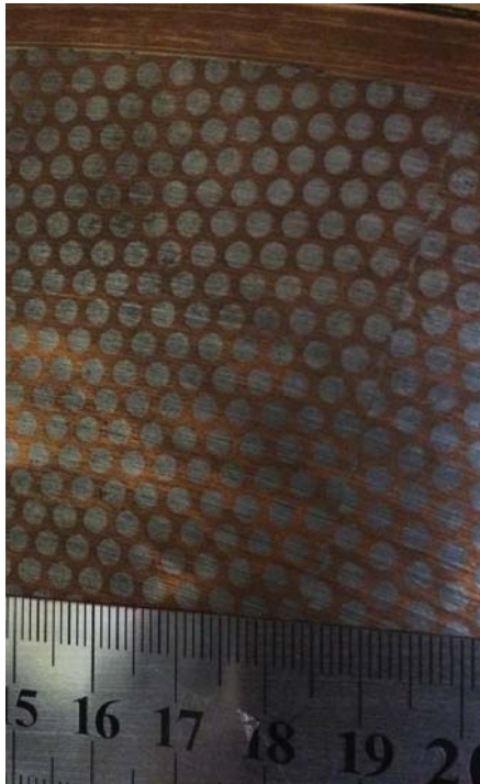
Figura 1-7: Ensamblaje de alambres de hierro embebidos en un volumen de cobre.
