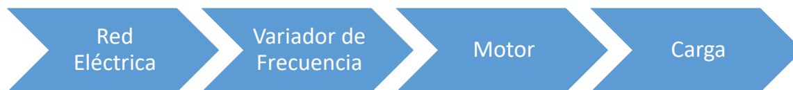
Figura 1: Esquema propuesto para accionamiento de cargas de gran inercia.
