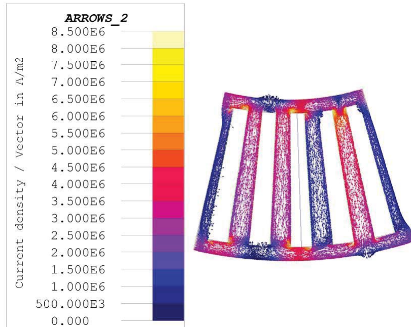
Figura 4-3: Distribución de la densidad de corriente en el modelo 3D de motor de inducción.
