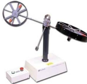
Figura A.2: Planta de control, Twin Rotor MIMO System, fabricado por Feedback Ltd.
