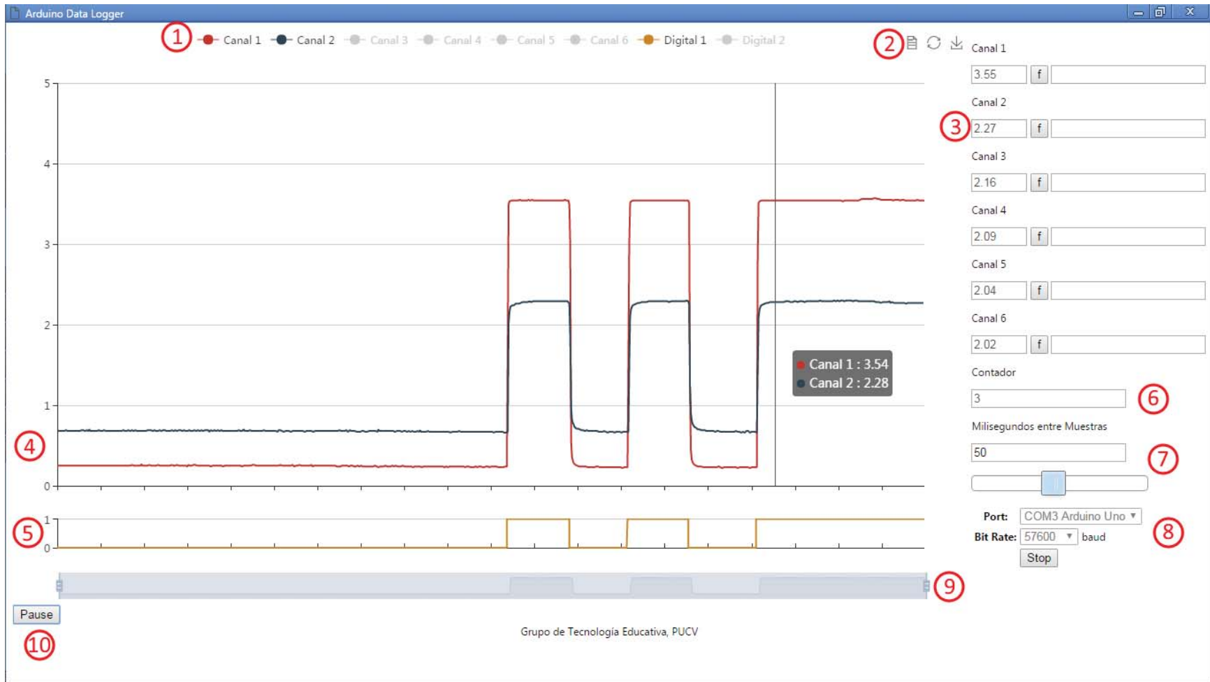
Figura 4-2: Interfaz programa en HTML5, dos señales son leídas desde los puertos analógicos del Arduino y mostrados en pantalla en conjunto con una entrada digital, el resto de las entradas se encuentran temporalmente deshabilitadas y por tanto no son visibles.
