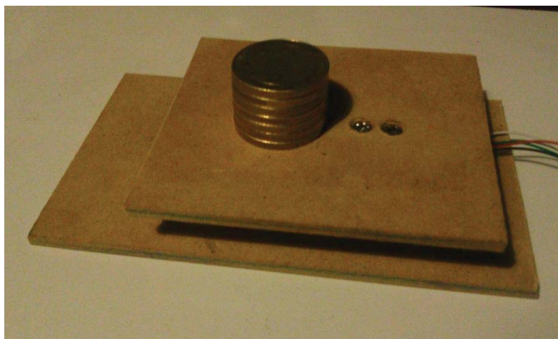
Figura 4-5: Pequeña plataforma utilizando la celda de carga para medir el peso de unas monedas.
