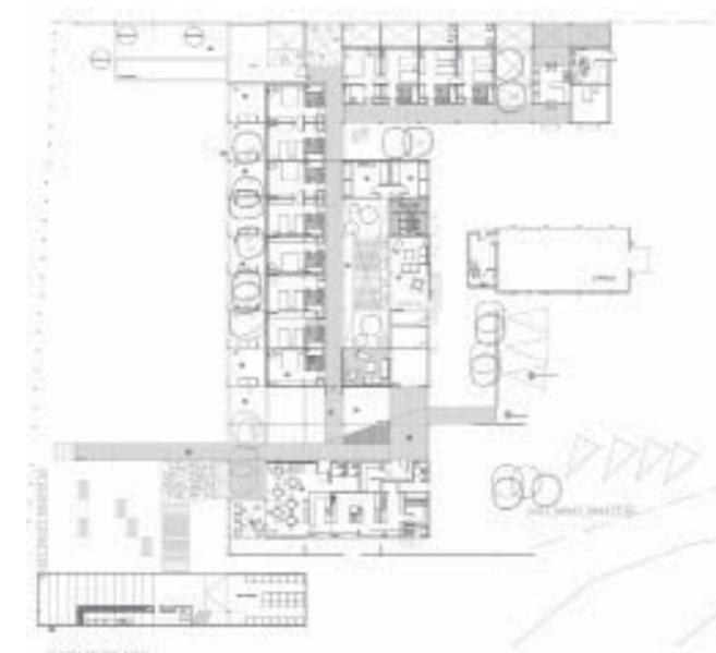
El hotel se proyectó basado en una trama de envigados de madera en módulos de 4x4 mts que organiza el programa mediante patios que mantienen permanentemente el edificio relacionado con el exterior. Esta trama se emplaza en una hilera de árboles existentes paralelos al mar.
