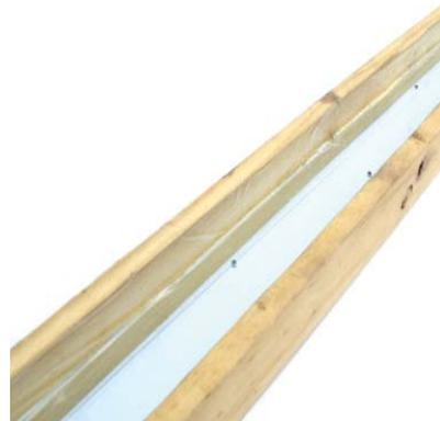
En esta propuesta se construye una unión constructiva de materiales, vinculando acrílico y madera, mejorando aún más el costo del acrílico.
