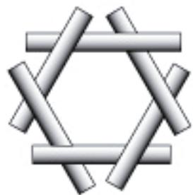
① Tensegrity estructura prisma triangular, hecha con 3 barras en compresión y 9 tensores
