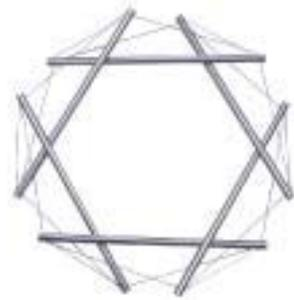
④ Tensegrity estructura prisma hexagonal, icosaedro hecho con 6 barras en compresión y 18 tensores. En nuestra experiencia realizada resultó ser la menos estable, pues es más difícil conseguir una tensión estructural con un número mayor de tensores, goza de alta flexibilidad.
