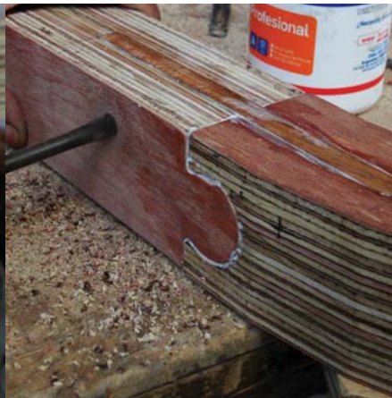
Se perfora la pieza en el otro sentido.
