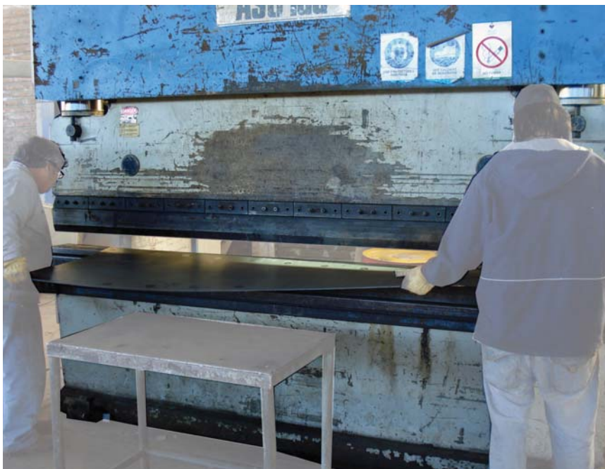
se calibra la plegadora y se coloca el cuerpo inferior
