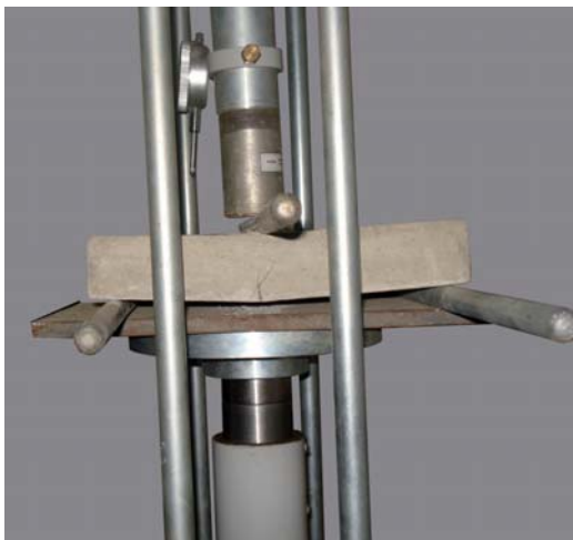
b. Loseta reforzada con malla de acero
