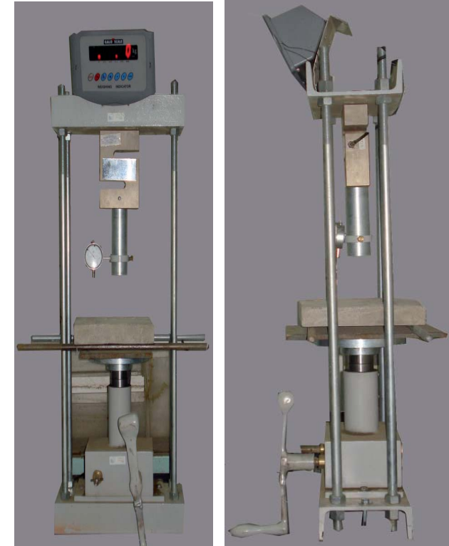
Prensa de ensayo mecánica. Sirve para realizar una compresión compacta, con bomba hidráulica de funcionamiento manual y tiene una lectura digital .
