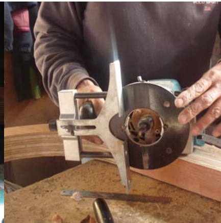
El router se ajusta con la profundidad adecuada.
