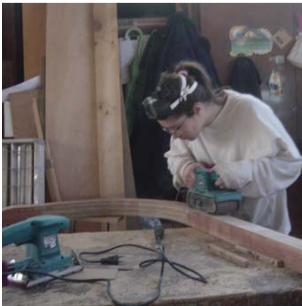
36 Se lija primero con una lija gruesa que rebaja las imperfecciones.
