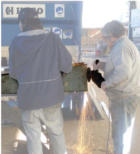
se esmerila base, para obtener perpendicularidad al suelo
