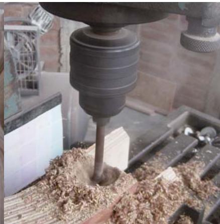
Taladro de pedestal perforando una pieza para la unión.
