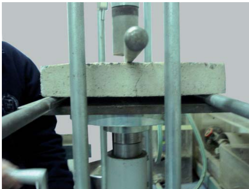
c. loseta reforzada con microfibras de polipropileno
