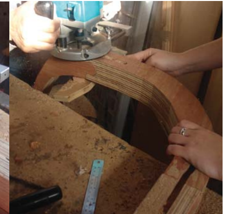
Se les hace el sacado a las 2 uniones de la pieza.
