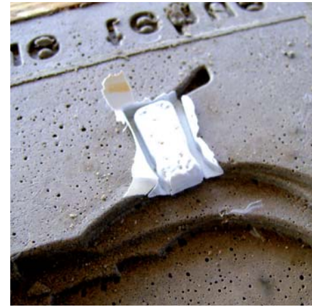
Al cabo de 7 días en la cámara dentro de su molde, la loseta se desmolda, quedando lista para ser puesta en uso después de 48 hrs. fuera de su matriz.
