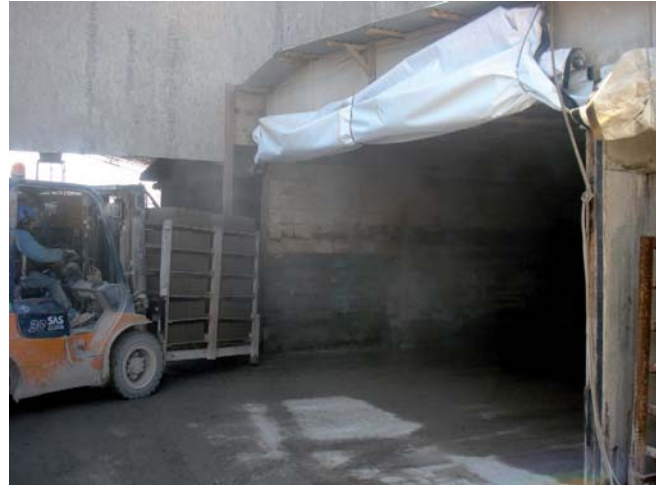
Cuando el hormigón ya está en su molde, allanado y compactado se lleva a la cámara húmeda de fraguado
