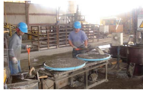
Encofrado se coloca sobre la mesa vibradora.
