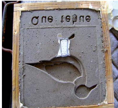
Al cabo de 7 días en la cámara dentro de su molde, la loseta se desmolda, quedando lista para ser puesta en uso después de 48 hrs. fuera de su matriz.
