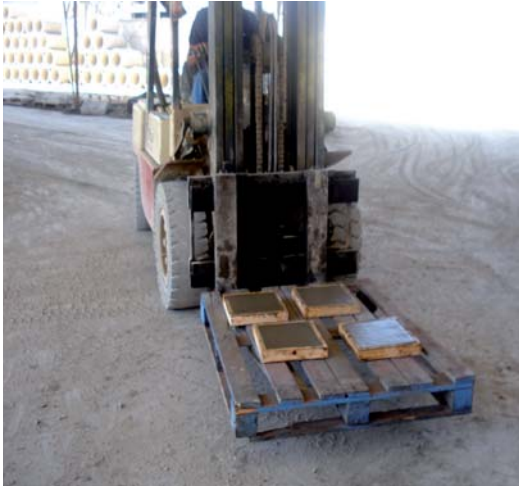
Cuando el hormigón ya está en su molde, allanado y compactado se lleva a la cámara húmeda de fraguado
