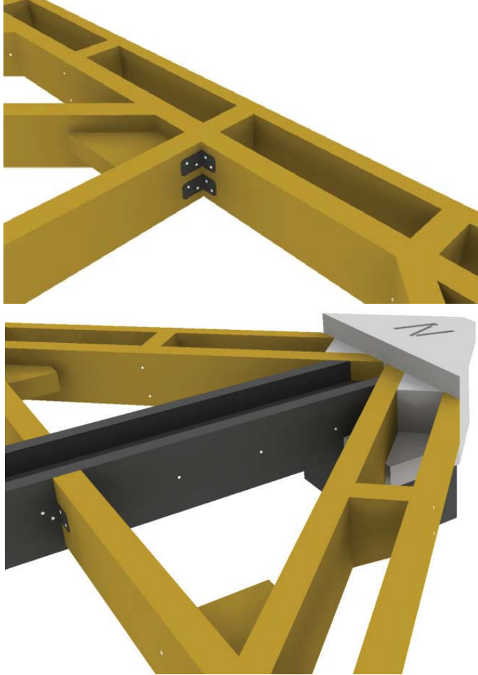
detalle de vínculo entre las piezas de madera y las escuadras hormigon.
