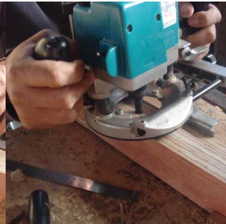
El router tiene una guía para que el sacado sea paralelo a la tabla.
