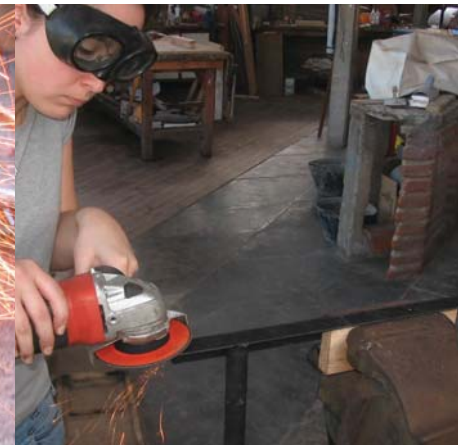
Con el esmeril se rebajan las imperfecciones.
