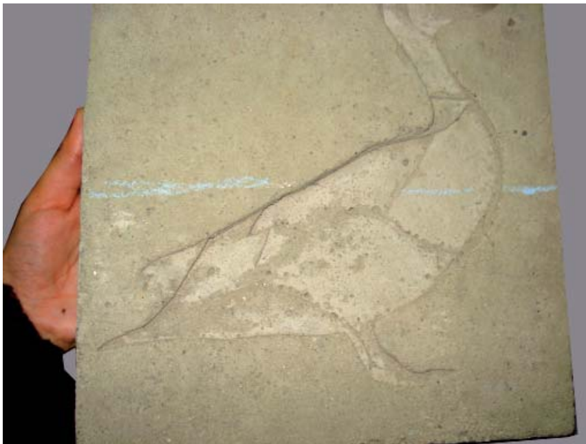
a. Loseta reforzada con malla de gallinero
