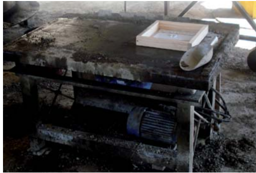
Encofrado se coloca sobre la mesa vibradora.
