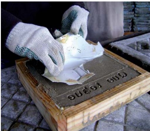
Al cabo de 7 días en la cámara dentro de su molde, la loseta se desmolda, quedando lista para ser puesta en uso después de 48 hrs. fuera de su matriz.
