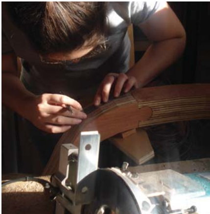
32 Se marca la pieza para pasar el router manual.
