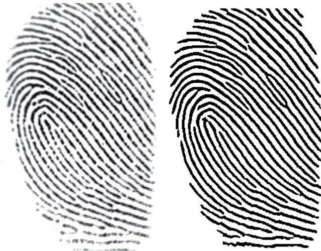
Figura 11: Comparación de una huella en escala de gris contra una binarizada
