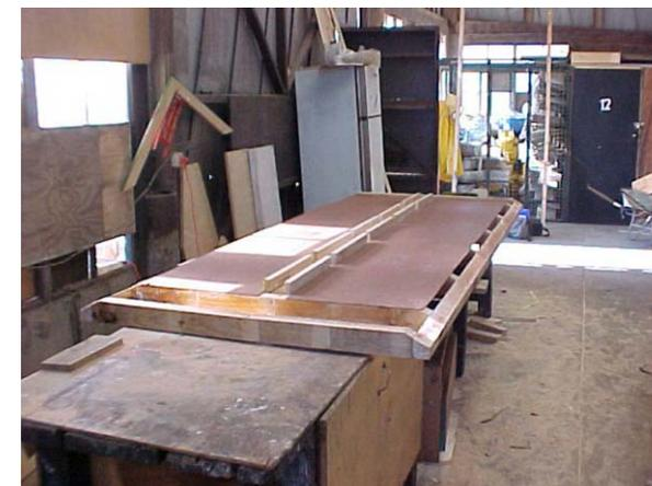
en bruto que resulta del corte oblicuo aplicado en las vigas laterales. Estas piezas se ubican en los costados de las vigas de suelo, a 5cm. de distancia, encoladas y atornilladas a la plancha de terciado (previo a su curvatura) con tornillos para volcánita de 1 5/8".
