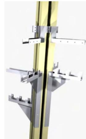
Un segundo diseño de conectores se plantea en otro nivel de complejidad, a partir de piezas metálicas con solicitaciones precisas. Amarrar el pilar para conformar su uniformidad en su sección a través de cuatro esquineros que a la vez reciben todas las piezas ya sean soldadas o apernadas. Un apoyo ortogonal y uno diagonal de las vigas a los pilares, transmitir la tensión de la viga al pilar. Un elemento que aprieta al pilar a modo de corona a la vez que recibe las vigas evitando su volcamiento.
