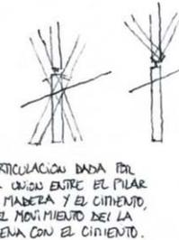
ARTICULACION DADA POR LA UNION ENTRE EL PILAR DE MADERA Y EL CEMENTO, Y EL MOVIMIENTO DE LA ARENA CON EL CEMENTO.
