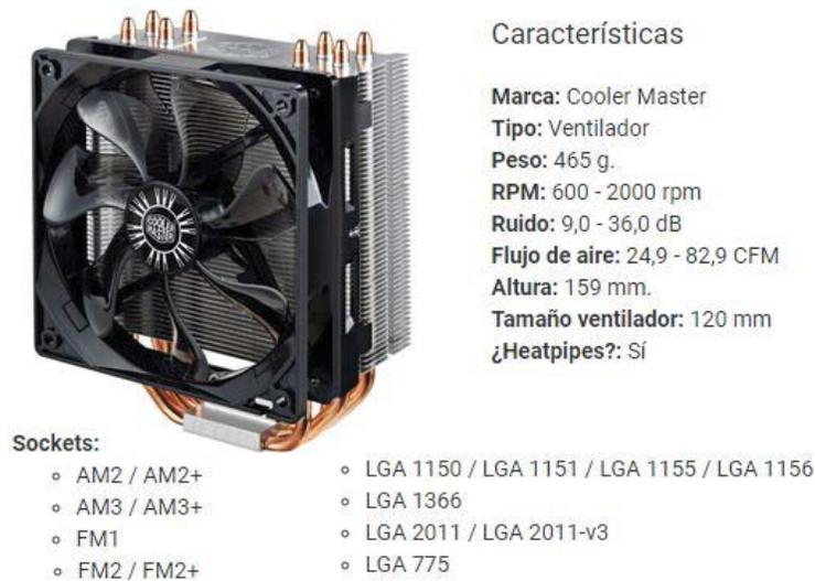
Figura 24: Resumen de las Características técnicas del enfriador, Fuente: (Cooler Master).
