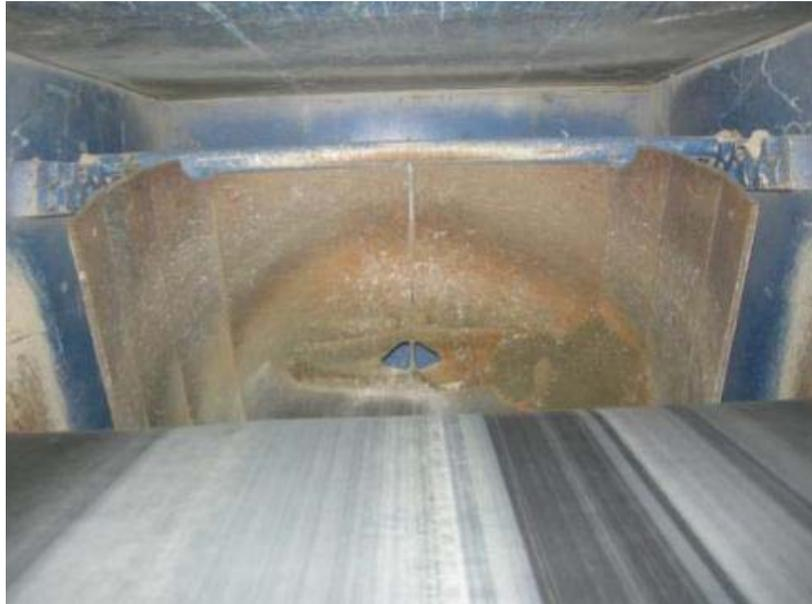
*Figura 13: Problema de desgaste en un punto de transferencia.
