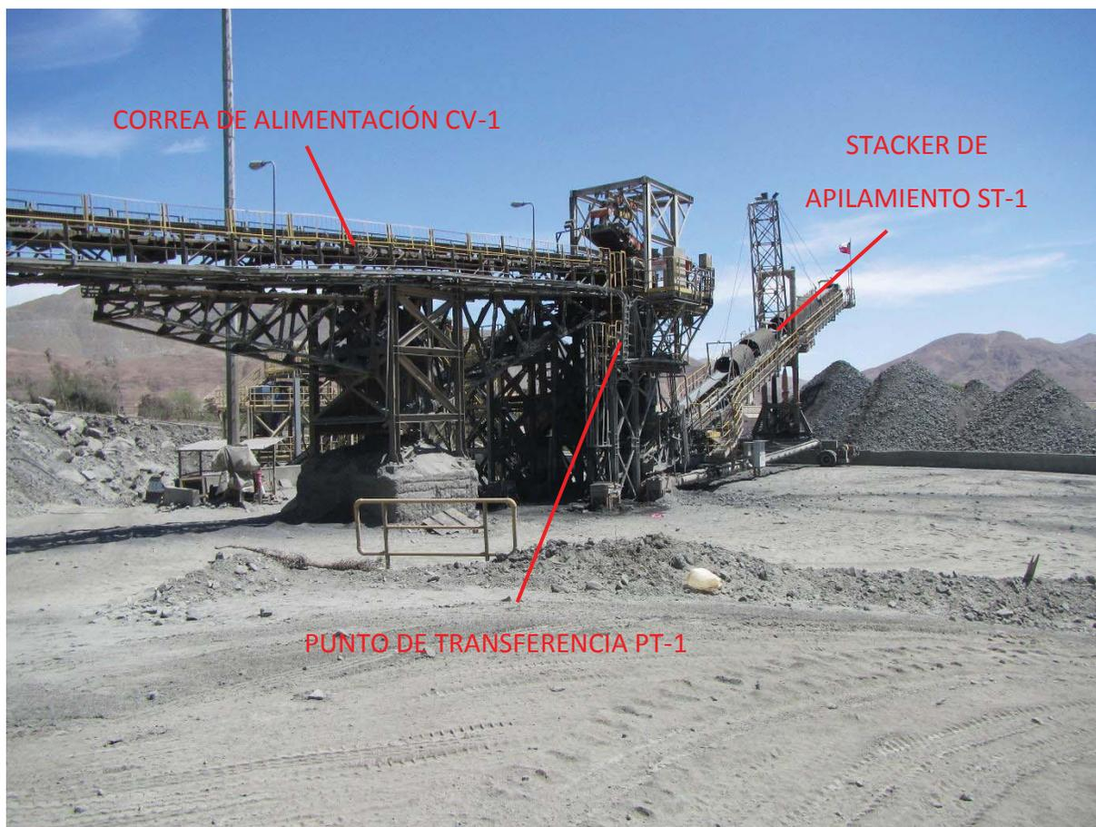
*Figura 9:Foto de la correa principal, punto de transferencia actual y stacker de apilamiento.
