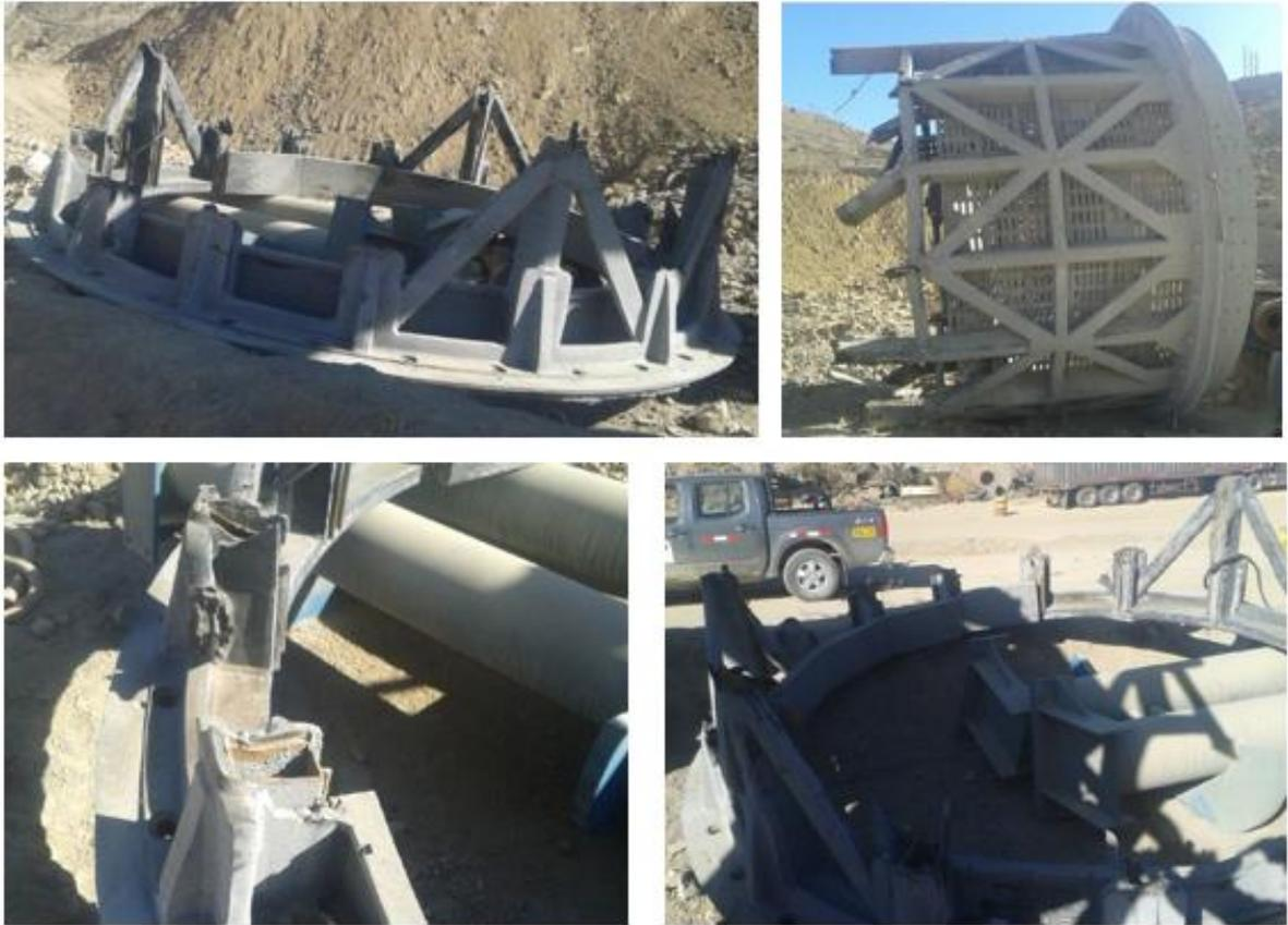
Figura N° 7: Fotos de falla de Trommel.
