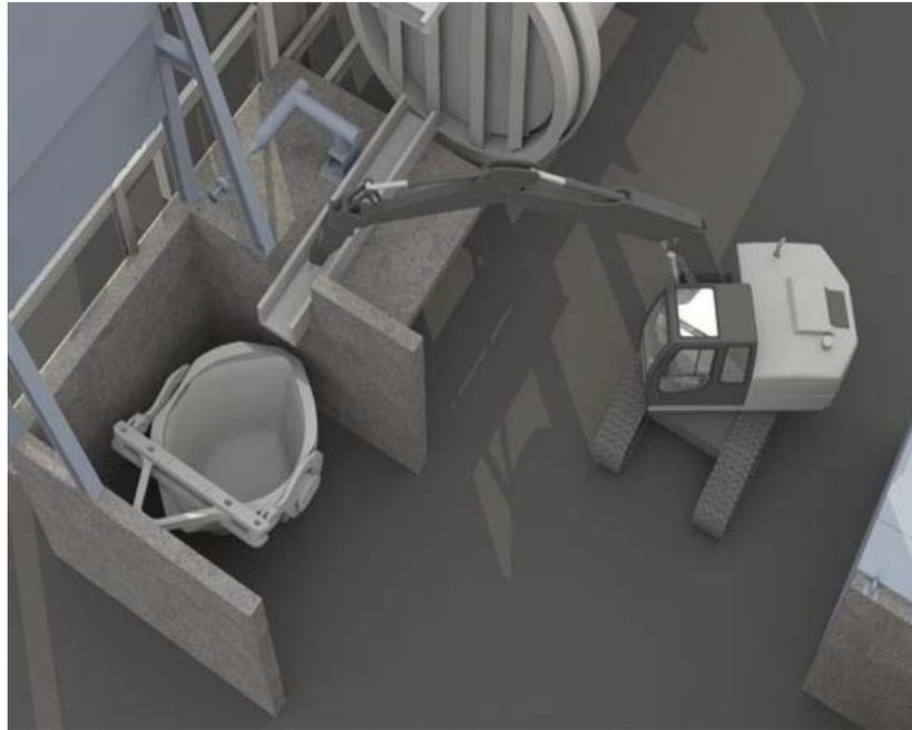
Figura 25 Maqueta limpieza de canala Alternativa N°1
