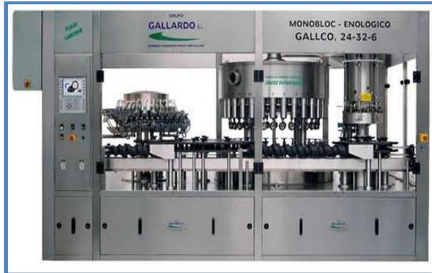
Figura N° 5: Equipo de embotellación, empresa Della Tofolla
