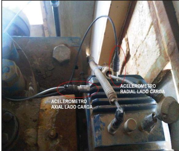
Figura 29 Detalle PIH lado Carga Axial y Radial. Acel.Axial y Radial.
