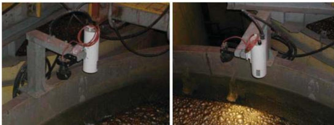
Figura 3-6: Disposición en terreno de cámara e iluminación. (Fuente: Metso Cisa)
