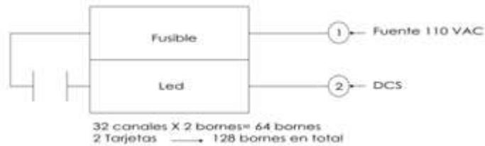
Figura 3-7. Conexión general de la tarjeta CC-TDI110.
