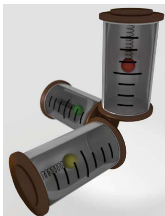
Figura 2-2: Acelerómetro mecánico de 3 ejes (fuente: http://atomosybits.com )
