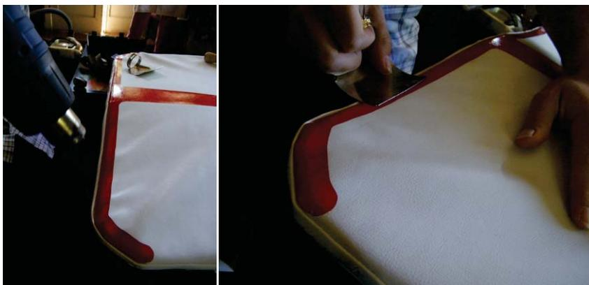
*Al adhesivo se le aplica calor y se le presiona contra la tela, para reforzar su unión. Al calentarse el plástico adhesivo se plasma en la superficie de, hecho comprobable en la adopción de la textura.*
