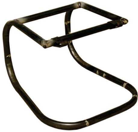
*La propuesta original tenía un único tubo continuo, pero el proceso constructivo se complicaba en la regulación de las secciones paralelas y se generaba un efecto de mecedora.*
