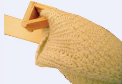
Las prendas se mantienen abiertas, para la entrada de la cabeza y retenidas, para mantener la tensión de la manga.
