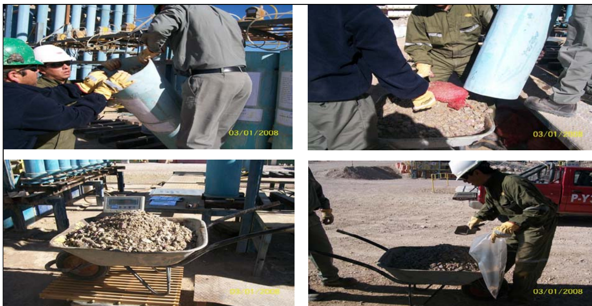
Figura B.13: Fotografía de secuencia de descarga de mineral, pesaje y toma de muestra de humedad.
