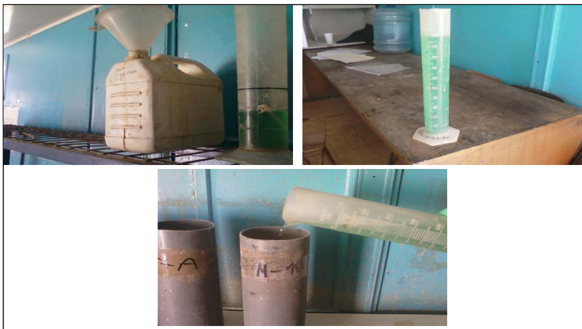
Figura D.2: Bidón de 5 l., probeta de 1000 ml. y humectación de mineral.
