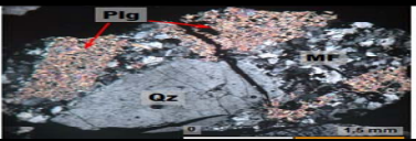
Fotomicrografía N°2. Fenocristales de Plagioclasa (Plg) reemplazados pseudomórficamente por Sericita. Fotomicrografía en Luz Transmitida. Nícoles Cruzados. Aumento 50x.
