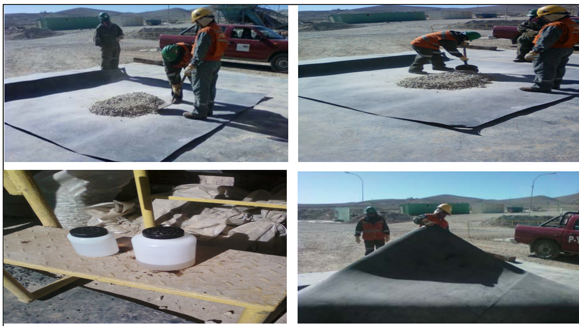
Figura B.12: Fotografía de secuencia de curado y aglomerado del mineral.
