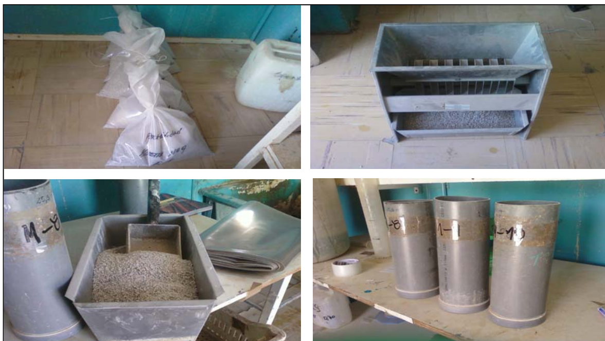
Figura D.1: Muestras de mineral, cortador rifle, bandeja con pala Jis y permémetros.
