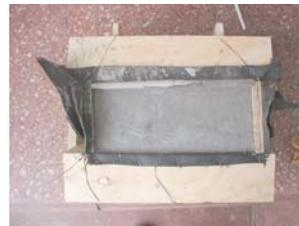
*3 vaciado de la mezcla.*
