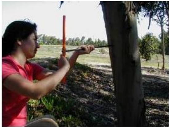
FIGURA 3. Obtención de muestras mediante barreno de un árbol vivo.
