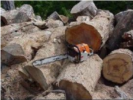
FIGURA 2. Obtención de muestras mediante motosierra de un árbol recientemente cortado.
