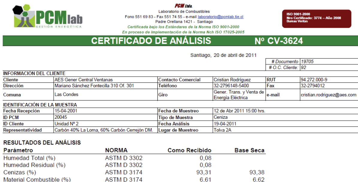
Fig. 87: Análisis de Ceniza Tomada en los P.E- 2A el 11 de Abril del 2011
