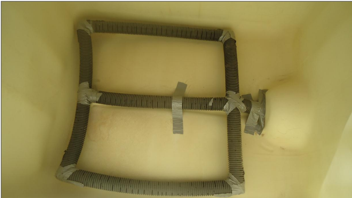
FIGURA 33: Diseño utilizado de la base del isocontenedor con Drenaflex.
