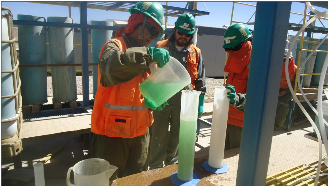
FIGURA 39: Operadores cuantificando solución lixivante para inicio de turno.
