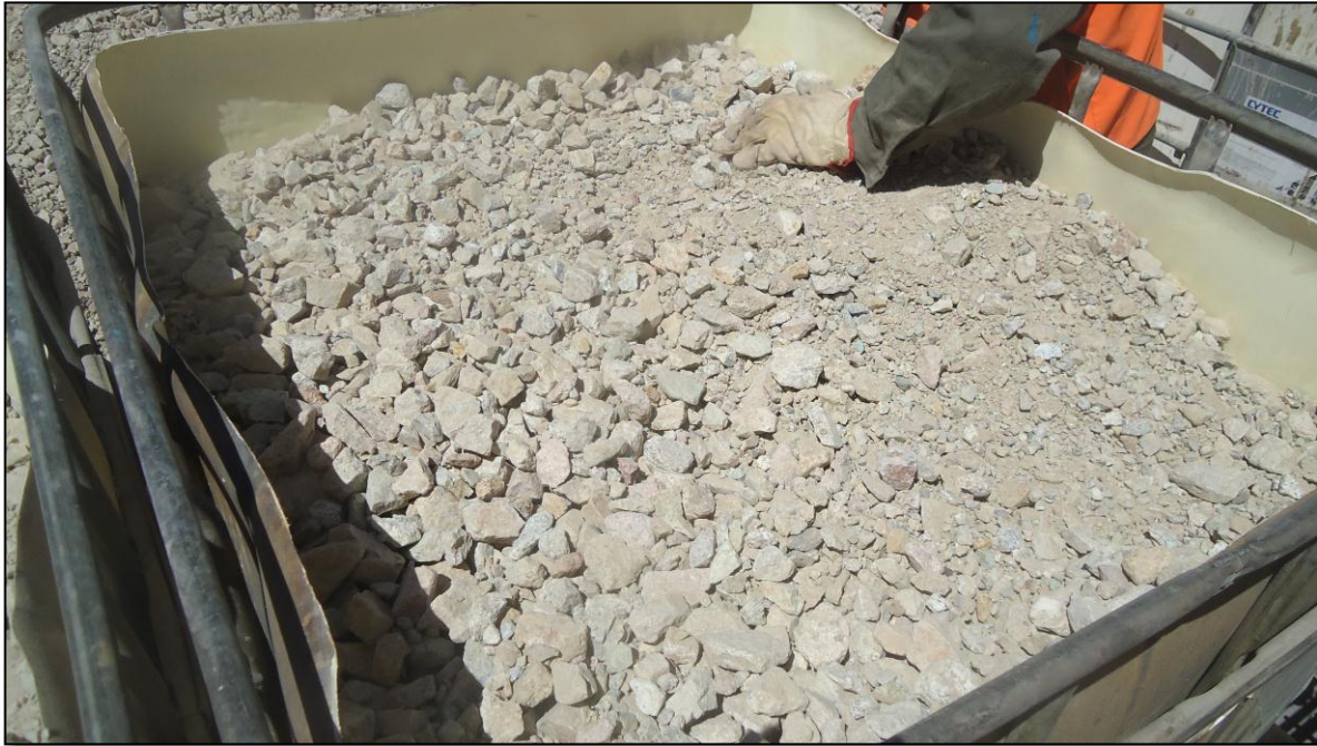
FIGURA 55: Isocontenedor cargado con mineral OBL de 6".
