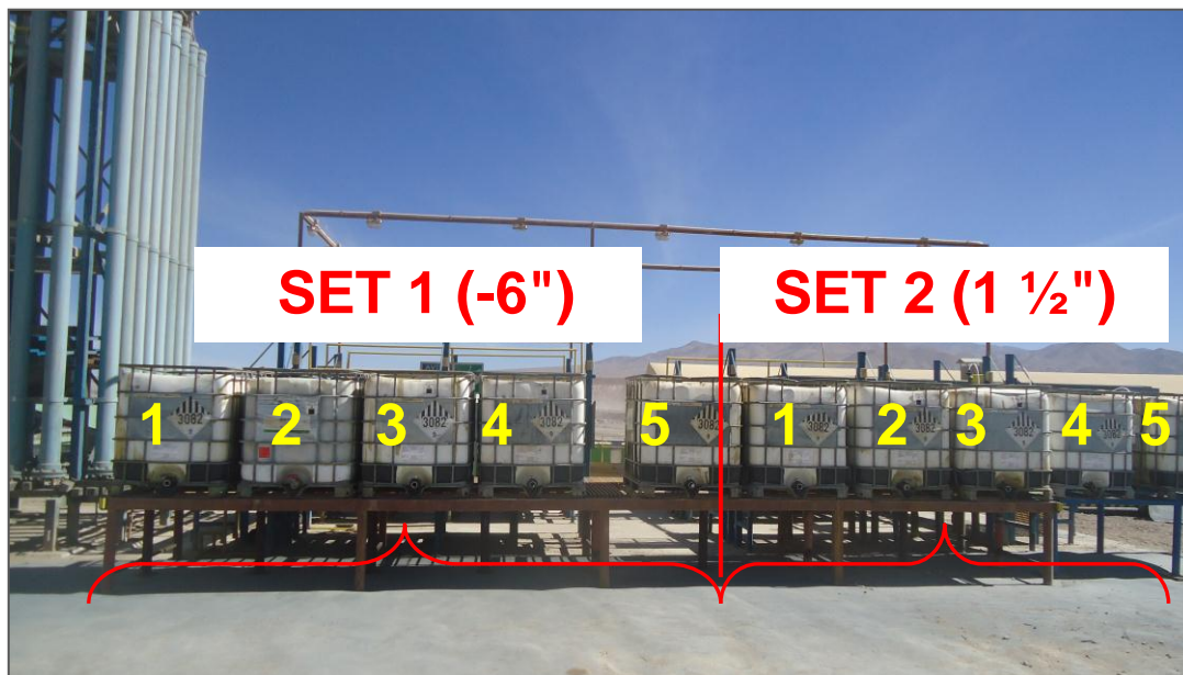
FIGURA 28: Esquema de las columnas en serie para mineral OBL, Planta Piloto RT - CODELCO, Chile.
