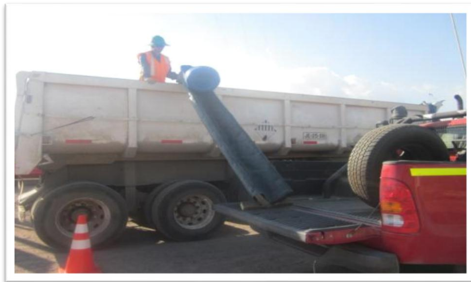
FIGURA 23: Descarga de toma de muestras de camión contenedor de Ripios.
