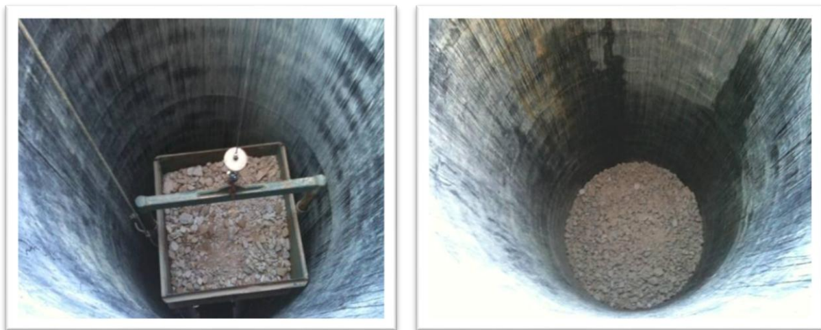
FIGURA 14: Carga de mineral en columnas de 6 metros (Planta Huechún), control de análisis granulométrico.
