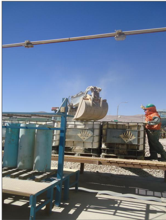
FIGURA 51: Carga de mineral con retroexcavadora a Isocontenedor.
