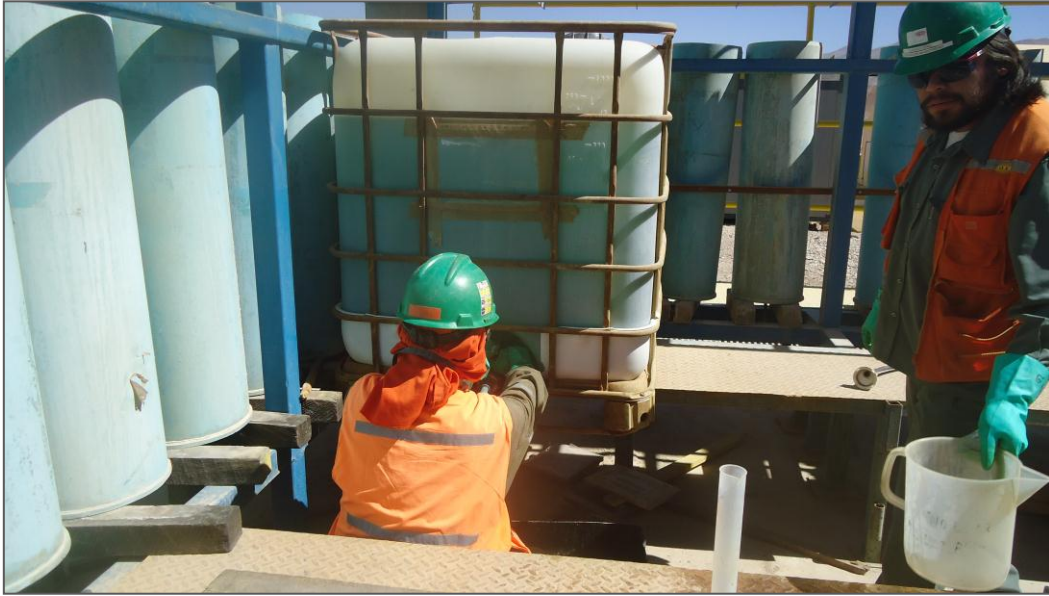
FIGURA 38: Isocontenedor con solución Lixivante (refino) al costado de pruebas metalúrgicas.
