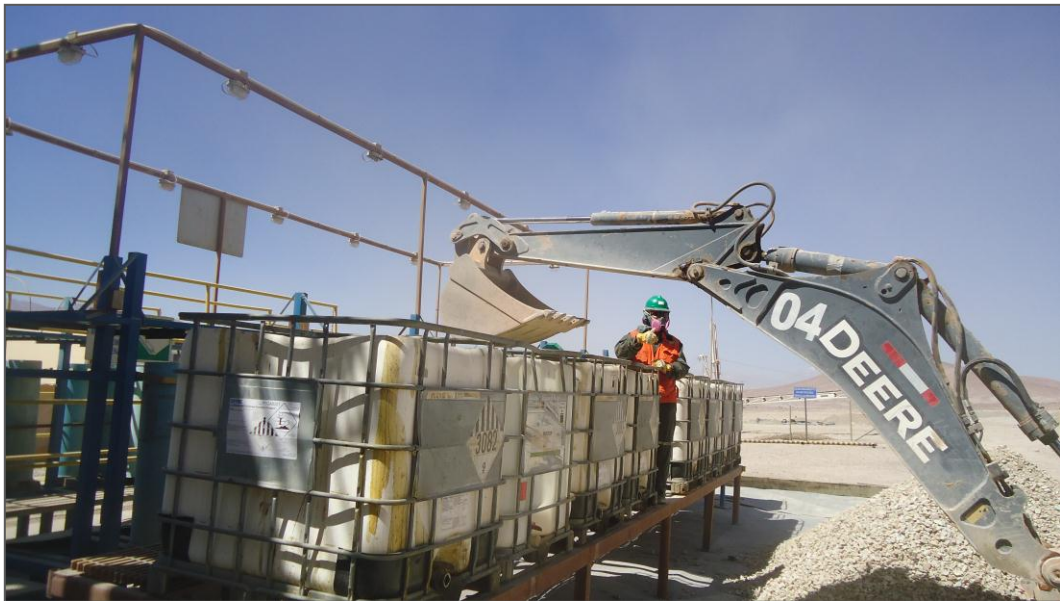
FIGURA 52: Carga de mineral con retroexcavadora a Isocontenedor.
