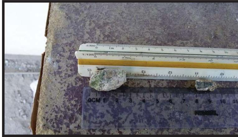
Figura 5.6 Comparación de tamaños y penetración del agente lixiviante.
