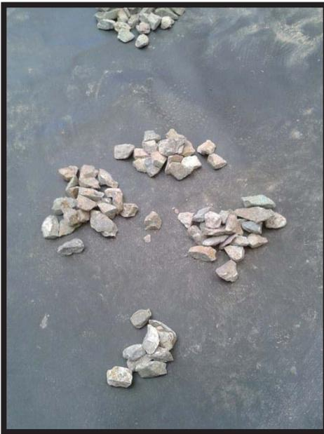
Figura 4.2 Cono y Cuarteo 2 para testigos de pruebas 1, 2 y 4
