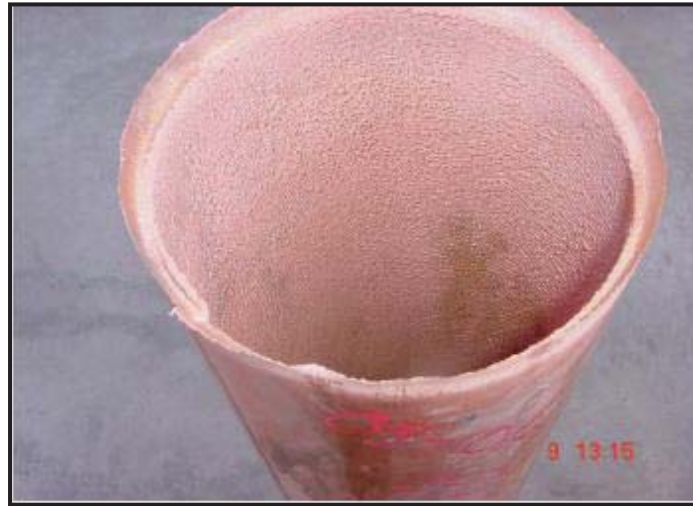
Figura 7.2: Cátodo obtenido en cosecha de celda EMEW®.
