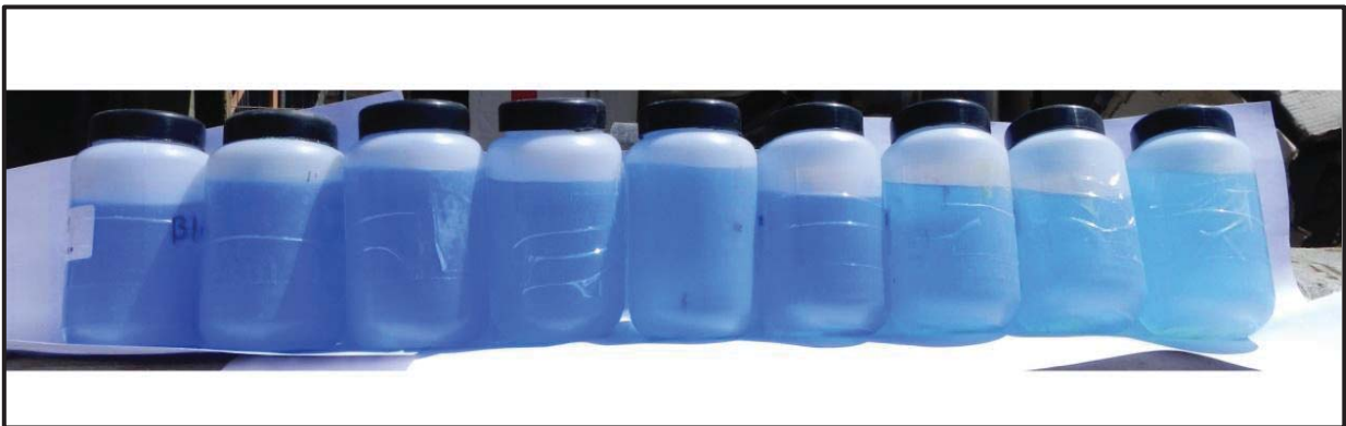
Figura 3.9: Secuencia de decoloración de Electrolito en el tiempo.
