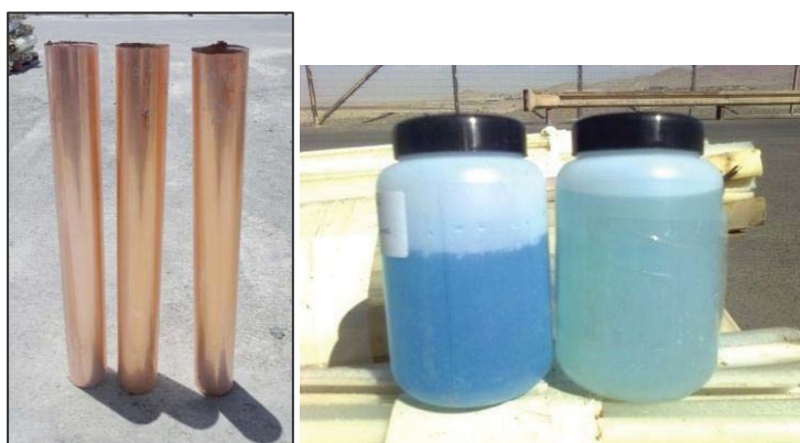
Figura 3.6: Cátodos obtenidos y decoloración de solución tratada.
