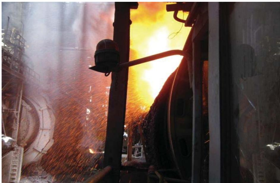
Figura 2.4 Giro de convertidor para cargar.
