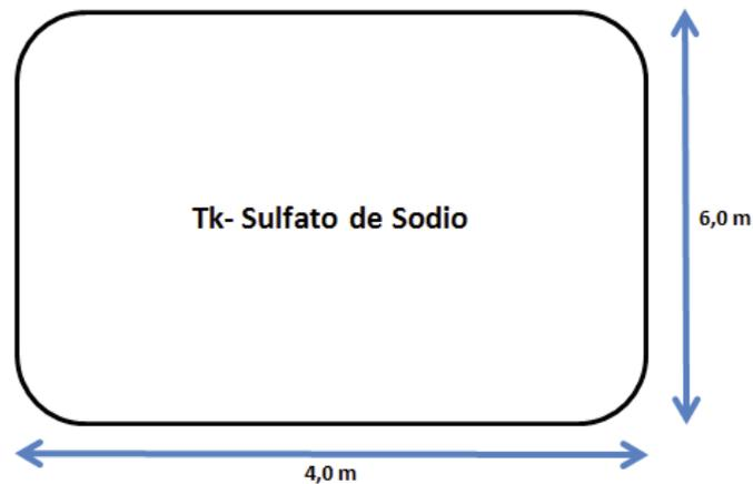
Figura 11.12: Dimensiones de Tk-Sulfato de Sodio
