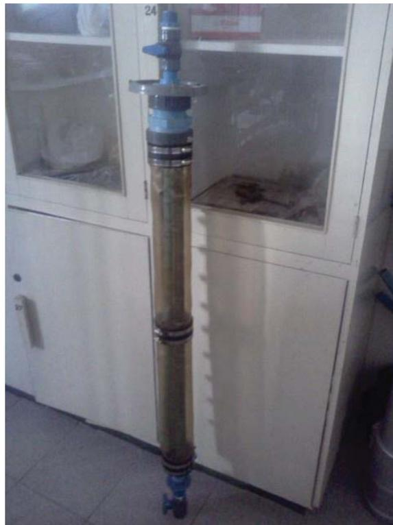
Figura11.6: Imagen de Membrana y Tubo de Solución Barren en Celda
