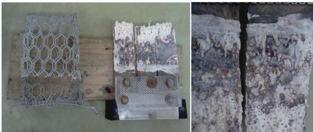
Figura 6.6: Imágenes de ánodo y cátodo en prueba experimental, sin membrana catiónica
