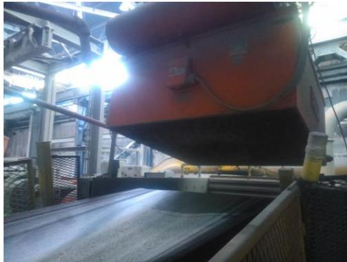
Figura 3.15: Electro imán correa alimentación Línea 1 en DET.
