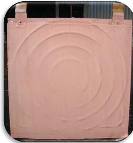
*Figura 11: Cátodo comercial de Ventanas clasificado como grado A*
