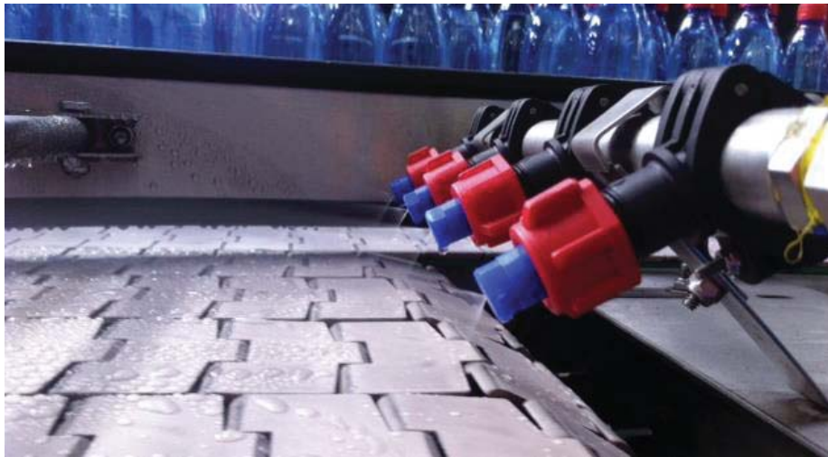
Figura 15. Aspersores de lubricación de Cintas Transportadoras.
