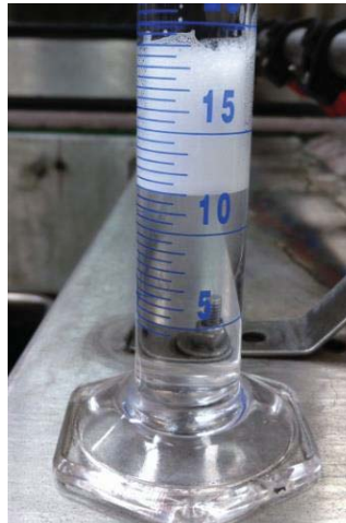
Figura 16. Medición del caudal de los aspersores en la Línea de Producción de Bidones.
