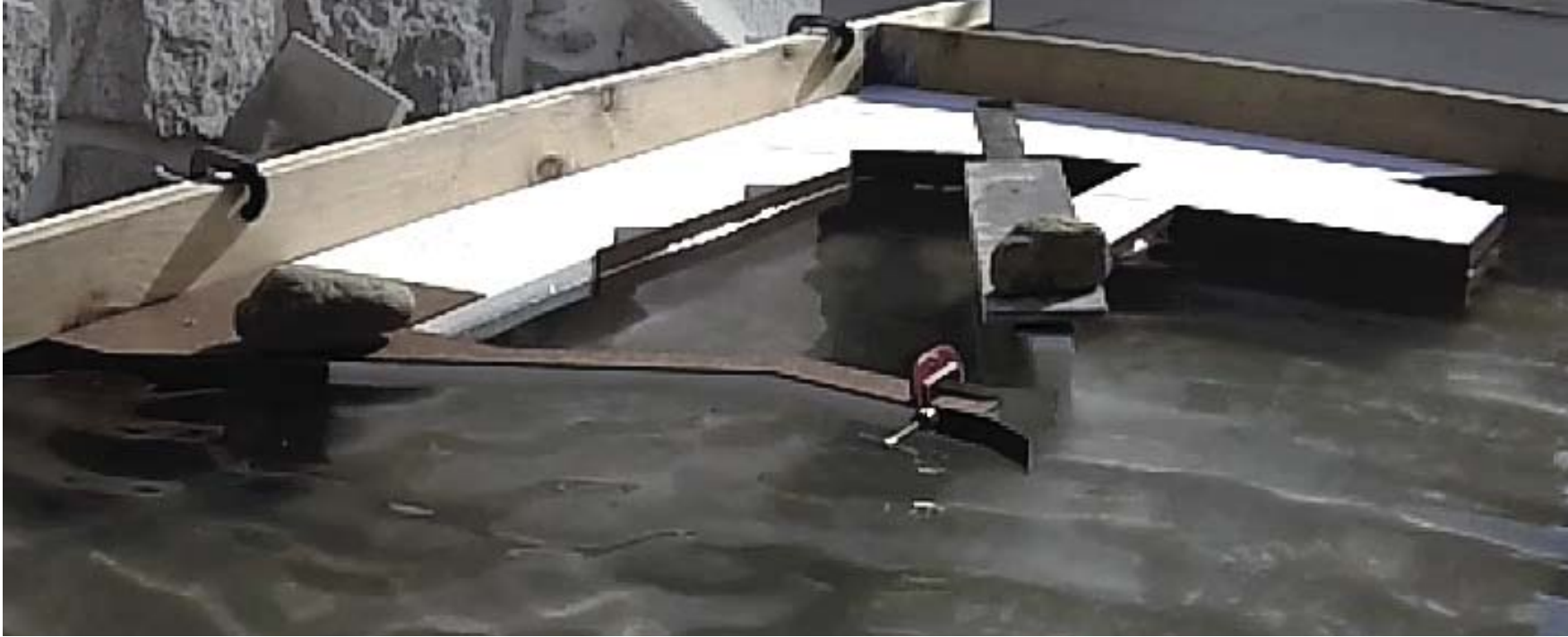
Fig. 83 Pruebas del modelo marítimo escala 1:200 – Detalle Perfil Muelle Flotante n° 3 con disipador bidente.
