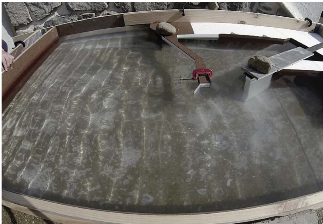
Fig. 84 Pruebas del modelo marítimo escala 1:200
