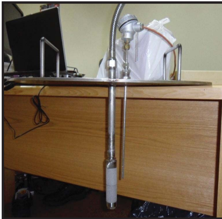
Figura 38. Tapa de prueba con flexible, inyector y termocupla conectados.
