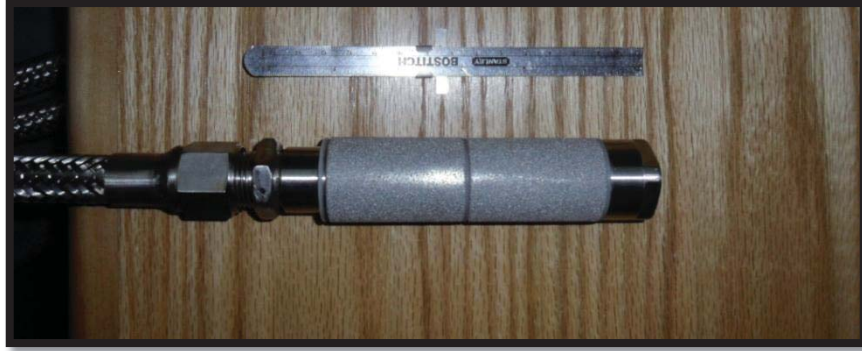
Figura 34. Inyector conectado al flexible, armado una vez se recibió de la maestranza de SARMAR.
