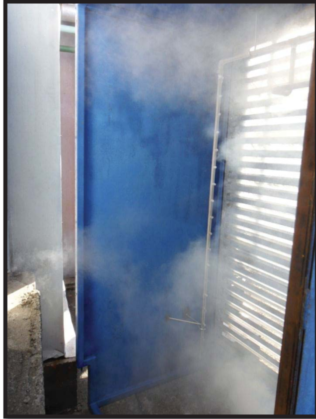
Figura 28. Fotografía del nitrógeno siendo inyectado por medio del arco de aspersores.
