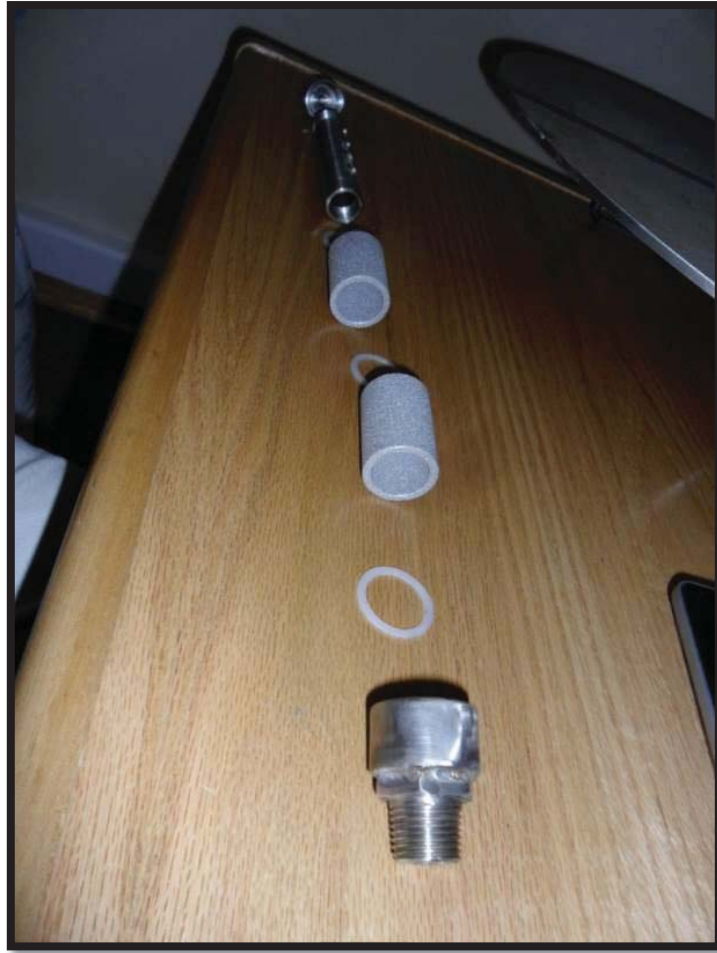
Figura 35. Partes por separado del inyector con las piezas corregidas en taller de soldadura.
