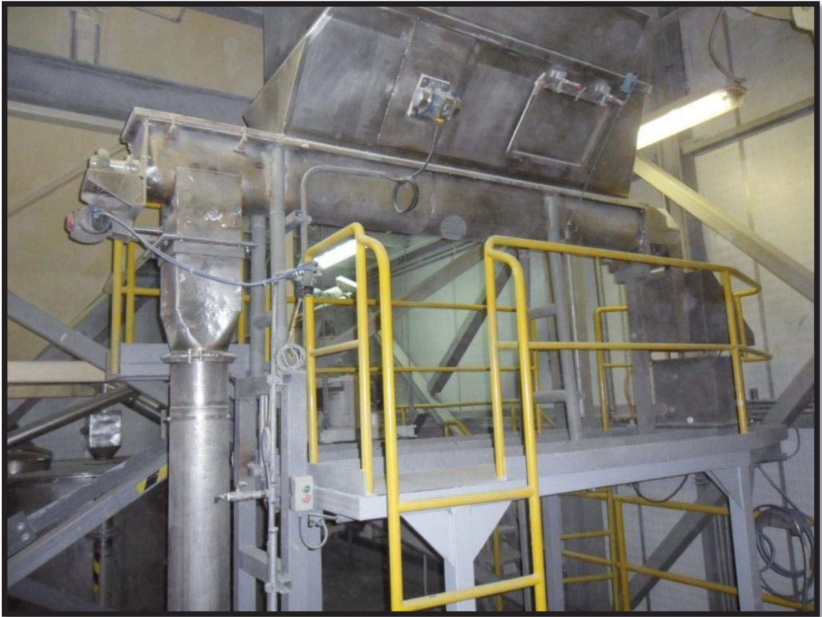
Figura 4. Parte inferior del silo del producto pre molido. También se aprecia el tornillo sin fin con el que se alimenta este producto al molino Long Gap.
