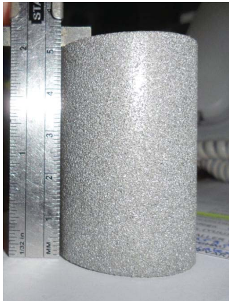
Figura 29. Fotografía de una de las piezas de cerámica con micro-poros facilitadas por Praxair.
