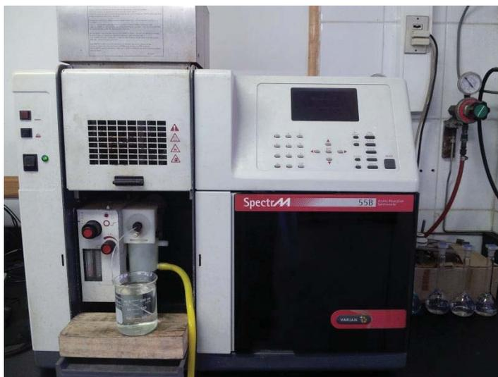
**Figura 8:** Absorbedor atómico utilizado para análisis de muestras.
