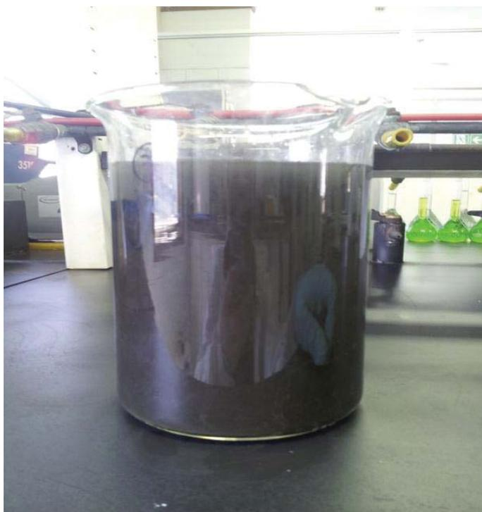
**Figura 10:** Agua de lavado de filtros inicialmente, antes de la precipitación.
