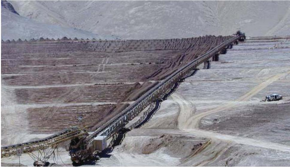
**Figura N° 5 Depósito de Relaves Filtrados.**
