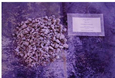
Figura 66 Aglomeración MA 4 Kg NaCl/TMS. 20 días. 10 Kg H 2 SO 4 /TMS, a 25°C y Presión atmosférica. [R s : 0,6]
