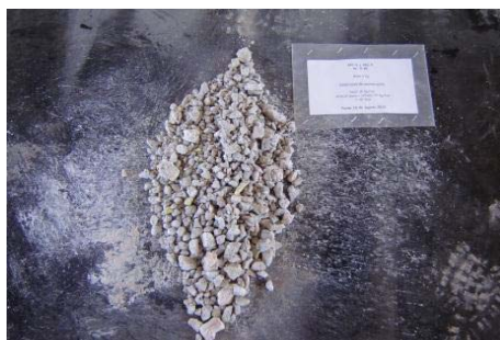
Figura 78 Aglomeración MA 10 Kg NaCl/TMS. 20 días. 10 Kg H 2 SO 4 /TMS, a 25°C y Presión atmosférica. [R s : 0,45]
