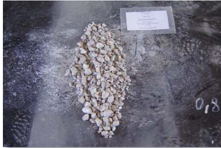
Figura 85 Aglomeración MA 10 Kg NaCl/TMS. 20 días. 10 Kg H 2 SO 4 /TMS, a 25°C y Presión atmosférica. [R s : 0,8]
