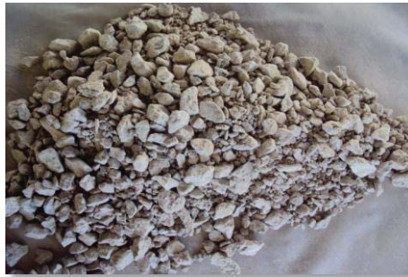
Figura 23 Aglomeración ARC 9 muestra Blanco. 10 Kg H_2SO_4 /TMS, a 25°C y Presión atmosférica. [10 días]
