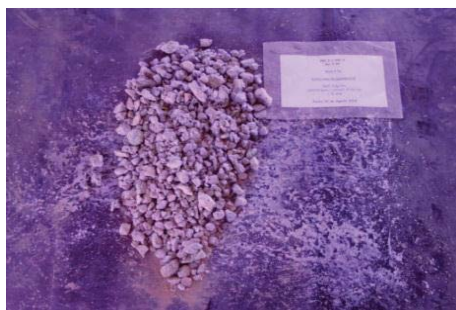
Figura 63 Aglomeración MA 4 Kg NaCl/TMS. 20 días. 10 Kg H 2 SO 4 /TMS, a 25°C y Presión atmosférica. [R s : 0,45]
