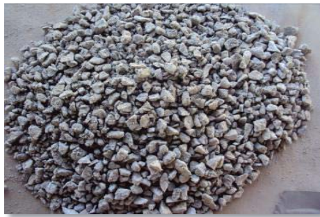
Figura 38 Aglomeración ARC 6 muestra 4 Kg NaCl/TMS. 10 Kg H_2SO_4 /TMS, a 25°C y Presión atmosférica. [10 días]
