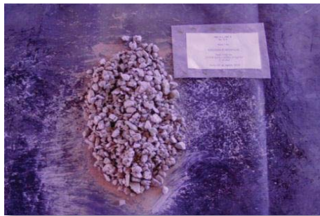
Figura 62 Aglomeración MA 4 Kg NaCl/TMS. 20 días. 10 Kg H 2 SO 4 /TMS, a 25°C y Presión atmosférica. [R s : 0,4]
