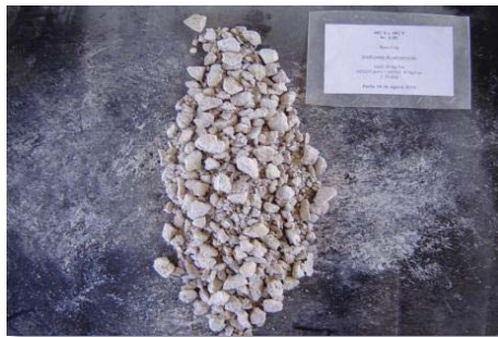
Figura 86 Aglomeración MA 10 Kg NaCl/TMS. 20 días. 10 Kg H 2 SO 4 /TMS, a 25°C y Presión atmosférica. [R s : 0,85]
