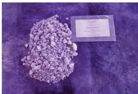
Figura 51 Aglomeración MA Blanco. 20 días. 10 Kg H_2SO_4 /TMS, a 25°C y Presión atmosférica. [ R_s : 0,6]
