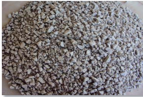
Figura 37 Aglomeración ARC 6 muestra Blanco. 10 Kg H_2SO_4 /TMS, a 25°C y Presión atmosférica. [10 días]
