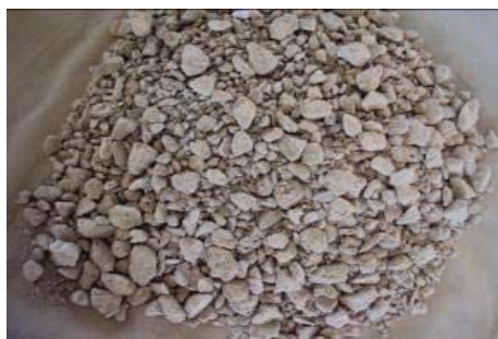
Figura 36 Aglomeración ARC 9 muestra 20 Kg NaCl/TMS. 10 Kg H 2 SO 4 /TMS, a 25°C y Presión atmosférica. [15 días]
