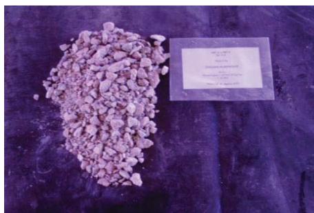
Figura 57 Aglomeración MA Blanco. 20 días. 10 Kg H_2SO_4 /TMS, a 25°C y Presión atmosférica. [ R_s : 0,9]
