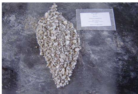
Figura 81 Aglomeración MA 10 Kg NaCl/TMS. 20 días. 10 Kg H 2 SO 4 /TMS, a 25°C y Presión atmosférica. [R s : 0,6]
