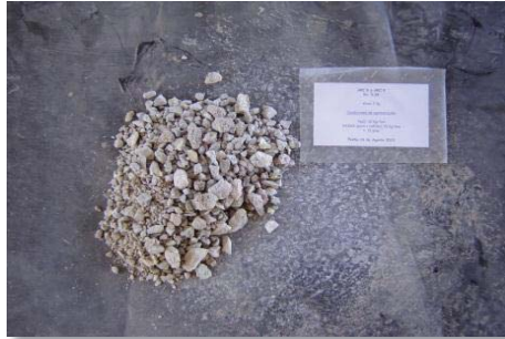
Figura 82 Aglomeración MA 10 Kg NaCl/TMS. 20 días. 10 Kg H 2 SO 4 /TMS, a 25°C y Presión atmosférica. [R s : 0,65]
