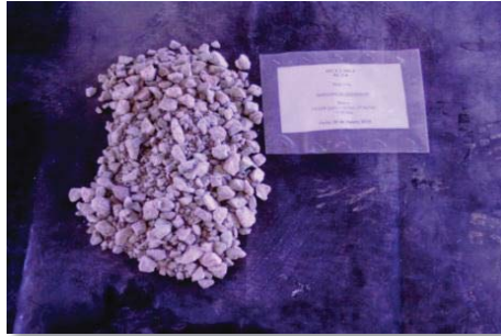
Figura 55 Aglomeración MA Blanco. 20 días. 10 Kg H_2SO_4 /TMS, a 25°C y Presión atmosférica. [ R_s : 0,8]
