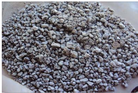
Figura 41 Aglomeración ARC 6 muestra 30 Kg NaCl/TMS. 10 Kg H 2 SO 4 /TMS, a 25°C y Presión atmosférica. [10 días]
