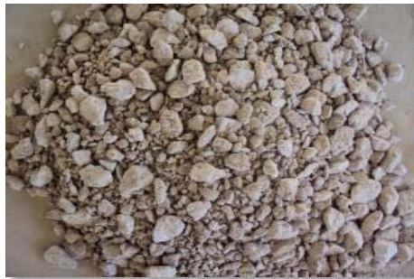
Figura 35 Aglomeración ARC 9 muestra 20 Kg NaCl/TMS. 10 Kg H 2 SO 4 /TMS, a 25°C y Presión atmosférica. [10 días]
