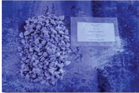
Figura 70 Aglomeración MA 4 Kg NaCl/TMS. 20 días. 10 Kg H 2 SO 4 /TMS, a 25°C y Presión atmosférica. [R s : 0,8]
