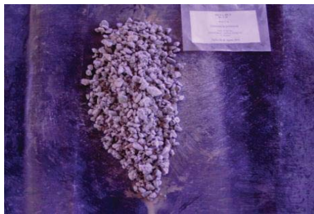
Figura 60 Aglomeración MA 4 Kg NaCl/TMS. 20 días. 10 Kg H 2 SO 4 /TMS, a 25°C y Presión atmosférica. [R s : 0,3]
