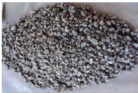
Figura 42 Aglomeración ARC 6 muestra 10 Kg NaCl/TMS, 5 Kg Fe 2 (SO 4 ) 3 /TMS. 10 Kg H 2 SO 4 /TMS, a 25°C y Presión atmosférica. [10 días]
