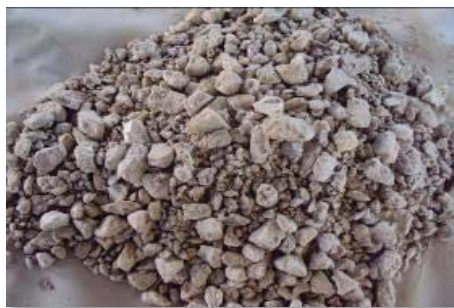
Figura 30 Aglomeración ARC 9 muestra 8 Kg NaCl/TMS. 10 Kg H 2 SO 4 /TMS, a 25°C y Presión atmosférica. [15 días]
