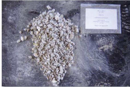
Figura 76 Aglomeración MA 10 Kg NaCl/TMS. 20 días. 10 Kg H 2 SO 4 /TMS, a 25°C y Presión atmosférica. [R s : 0,35]
