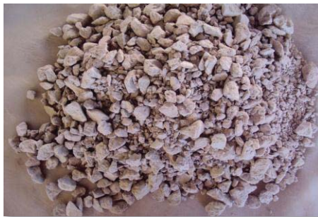
Figura 24 Aglomeración ARC 9 muestra Blanco. 10 Kg H_2SO_4 /TMS, a 25°C y Presión atmosférica. [15 días]
