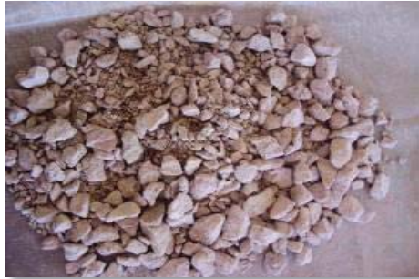
Figura 28 Aglomeración ARC 9 muestra 8 Kg NaCl/TMS. 10 Kg H 2 SO 4 /TMS, a 25°C y Presión atmosférica. [5 días]
