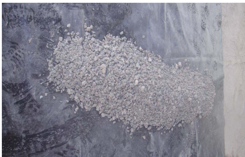
Figura 91 Aglomeración MA 10 Kg NaCl/TMS y 5 Kg Fe 2 (SO 4 ) 3 /TMS. Columna Ceres [R s : 0,6]
