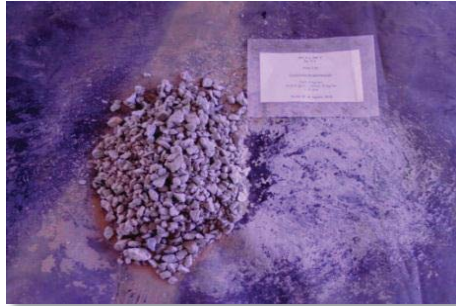
Figura 58 Aglomeración MA 4 Kg NaCl/TMS. 20 días. 10 Kg H 2 SO 4 /TMS, a 25°C y Presión atmosférica. [R s : 0,2]
