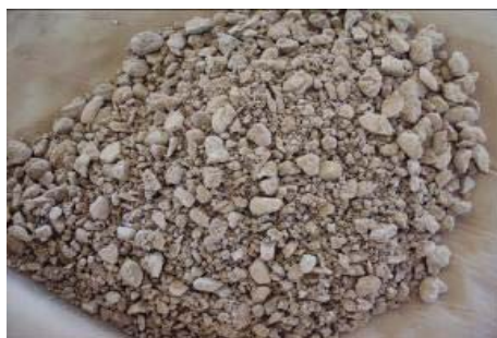
Figura 33 Aglomeración ARC 9 muestra 10 Kg NaCl/TMS. 10 Kg H 2 SO 4 /TMS, a 25°C y Presión atmosférica. [15 días]
