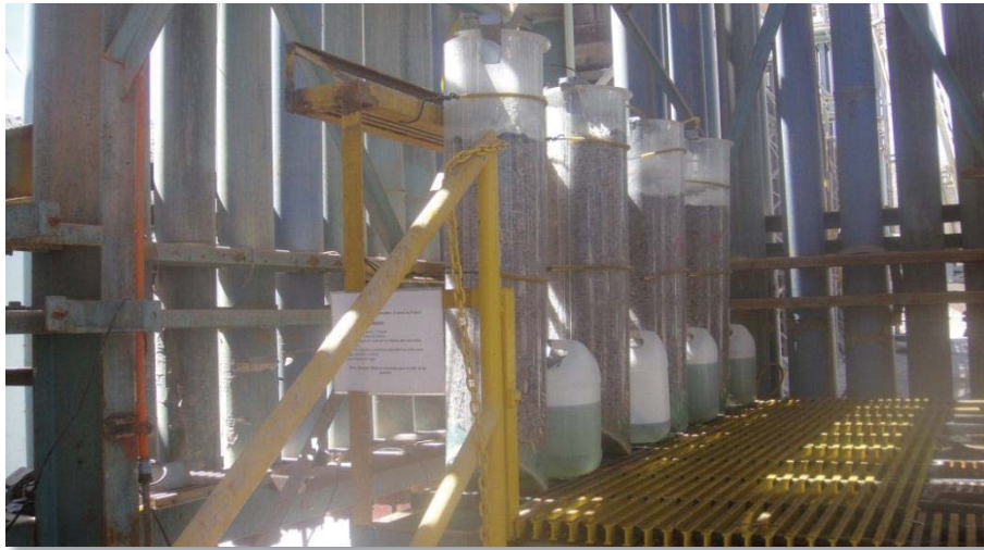
Figura 96 Lixiviación en Columnas Planta Piloto CMCC
