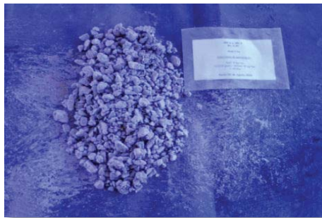
Figura 65 Aglomeración MA 4 Kg NaCl/TMS. 20 días. 10 Kg H 2 SO 4 /TMS, a 25°C y Presión atmosférica. [R s : 0,55]
