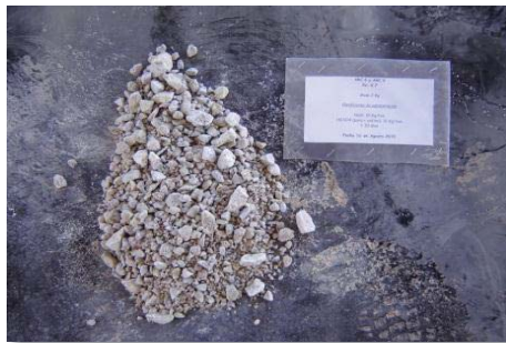
Figura 83 Aglomeración MA 10 Kg NaCl/TMS. 20 días. 10 Kg H 2 SO 4 /TMS, a 25°C y Presión atmosférica. [R s : 0,7]
