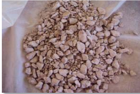
Figura 34 Aglomeración ARC 9 muestra 20 Kg NaCl/TMS. 10 Kg H 2 SO 4 /TMS, a 25°C y Presión atmosférica. [5 días]
