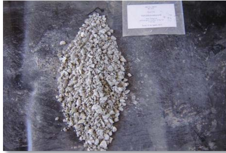
Figura 73 Aglomeración MA 10 Kg NaCl/TMS. 20 días. 10 Kg H 2 SO 4 /TMS, a 25°C y Presión atmosférica. [R s : 0,2]
