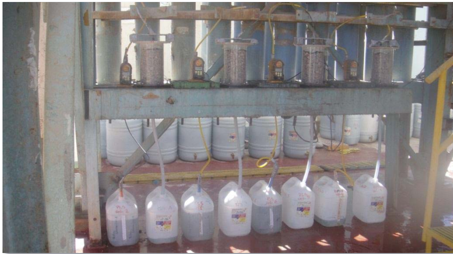
Figura 97 Lixiviación Columna Ceres en Serie Planta Piloto CMCC
