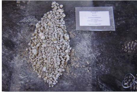
Figura 79 Aglomeración MA 10 Kg NaCl/TMS. 20 días. 10 Kg H 2 SO 4 /TMS, a 25°C y Presión atmosférica. [R s : 0,5]
