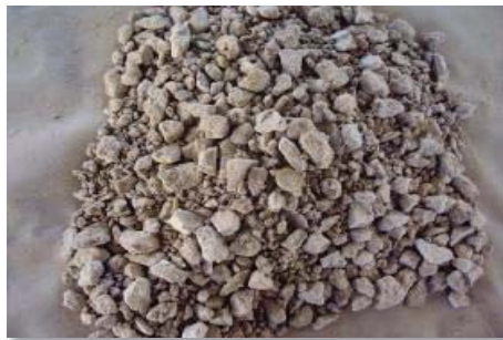
Figura 29 Aglomeración ARC 9 muestra 8 Kg NaCl/TMS. 10 Kg H 2 SO 4 /TMS, a 25°C y Presión atmosférica. [10 días]
