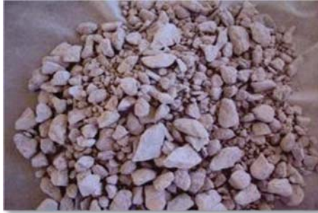
Figura 25 Aglomeración ARC 9 muestra 4 Kg NaCl/TMS. 10 Kg H 2 SO 4 /TMS, a 25°C y Presión atmosférica. [5 días]
