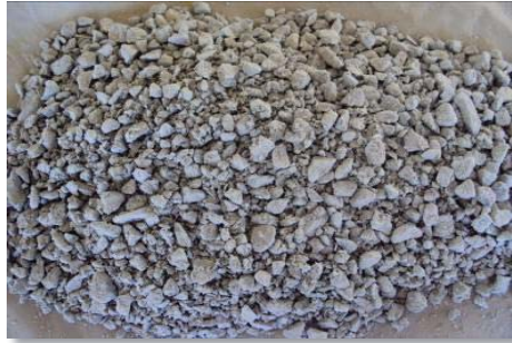
Figura 40 Aglomeración ARC 6 muestra 20 Kg NaCl/TMS. 10 Kg H 2 SO 4 /TMS, a 25°C y Presión atmosférica. [10 días]
