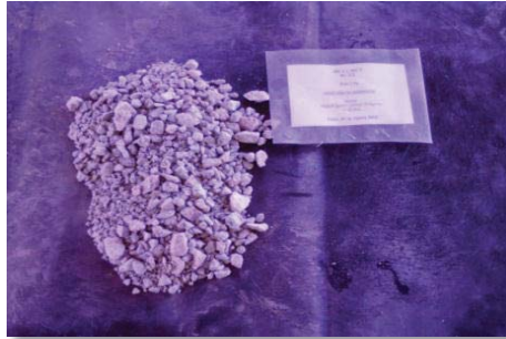
Figura 49 Aglomeración MA Blanco. 20 días. 10 Kg H_2SO_4 /TMS, a 25°C y Presión atmosférica. [ R_s : 0,5]
