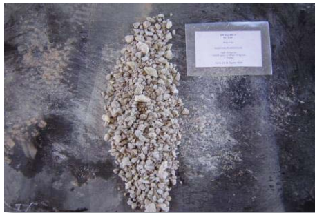
Figura 80 Aglomeración MA 10 Kg NaCl/TMS. 20 días. 10 Kg H 2 SO 4 /TMS, a 25°C y Presión atmosférica. [R s : 0,55]
