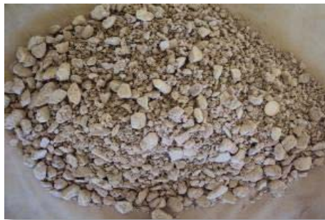
Figura 32 Aglomeración ARC 9 muestra 10 Kg NaCl/TMS. 10 Kg H 2 SO 4 /TMS, a 25°C y Presión atmosférica. [10 días]
