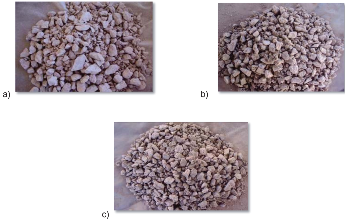
Figura 15 Aglomeración ARC 9 muestra 4 Kg NaCl/TMS. 10 Kg H 2 SO 4 /TMS, a 25°C y Presión atmosférica. ( a) 5 días, b) 10 días, c) 15 días)
