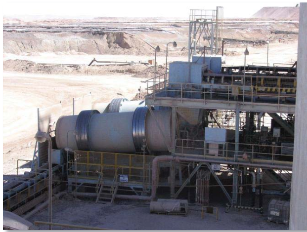
Figura 4 Tambor aglomerador Compañía Minera Cerro Colorado
