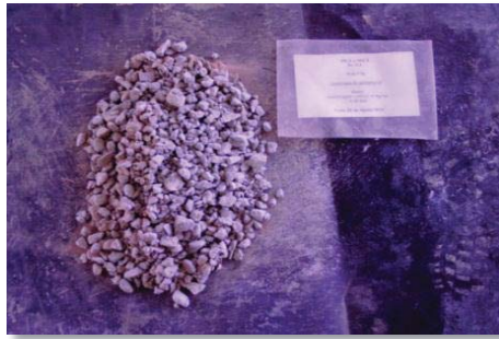
Figura 43 Aglomeración MA Blanco. 20 días. 10 Kg H 2 SO 4 /TMS, a 25°C y Presión atmosférica. [R s : 0,2]
