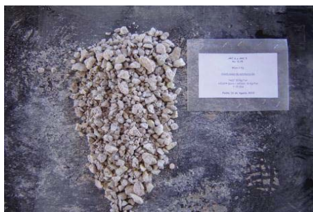
Figura 84 Aglomeración MA 10 Kg NaCl/TMS. 20 días. 10 Kg H 2 SO 4 /TMS, a 25°C y Presión atmosférica. [R s : 0,75]
