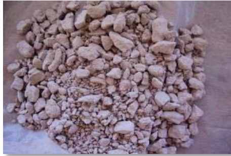
Figura 31 Aglomeración ARC 9 muestra 10 Kg NaCl/TMS. 10 Kg H 2 SO 4 /TMS, a 25°C y Presión atmosférica. [5 días]
