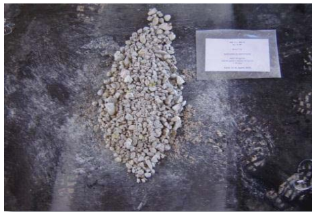
Figura 74 Aglomeración MA 10 Kg NaCl/TMS. 20 días. 10 Kg H 2 SO 4 /TMS, a 25°C y Presión atmosférica. [R s : 0,25]
