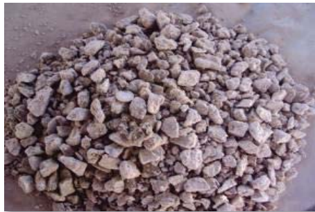
Figura 26 Aglomeración ARC 9 muestra 4 Kg NaCl/TMS. 10 Kg H 2 SO 4 /TMS, a 25°C y Presión atmosférica. [10 días]
