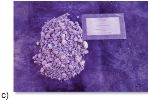
Figura 17 Aglomeración MA Blanco. 20 días. 10 Kg H_2SO_4 /TMS, a 25°C y Presión atmosférica. ( a) Rs: 0,5, b) Rs: 0,55, c) Rs:0,6 )
