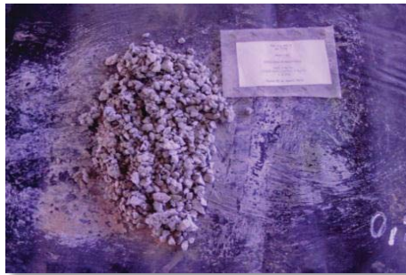
Figura 59 Aglomeración MA 4 Kg NaCl/TMS. 20 días. 10 Kg H 2 SO 4 /TMS, a 25°C y Presión atmosférica. [R s : 0,25]
