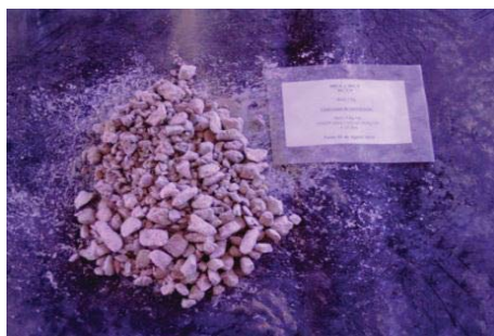
Figura 72 Aglomeración MA 4 Kg NaCl/TMS. 20 días. 10 Kg H 2 SO 4 /TMS, a 25°C y Presión atmosférica. [R s : 0,9]
