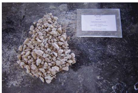
Figura 87 Aglomeración MA 10 Kg NaCl/TMS. 20 días. 10 Kg H 2 SO 4 /TMS, a 25°C y Presión atmosférica. [R s : 0,9]
