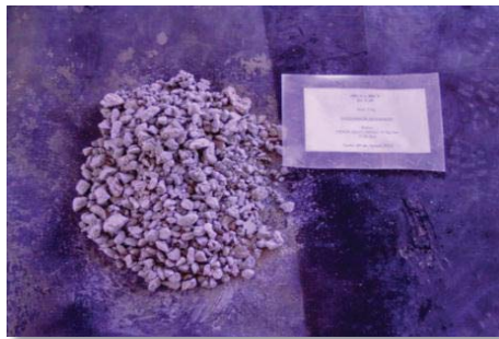
Figura 44 Aglomeración MA Blanco. 20 días. 10 Kg H 2 SO 4 /TMS, a 25°C y Presión atmosférica. [R s : 0,25]
