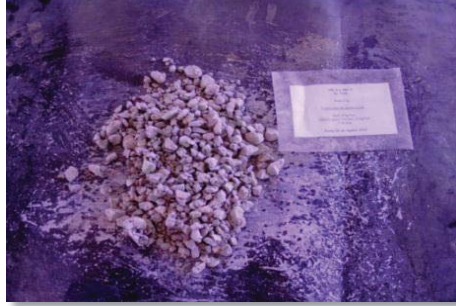
Figura 67 Aglomeración MA 4 Kg NaCl/TMS. 20 días. 10 Kg H 2 SO 4 /TMS, a 25°C y Presión atmosférica. [R s : 0,65]
