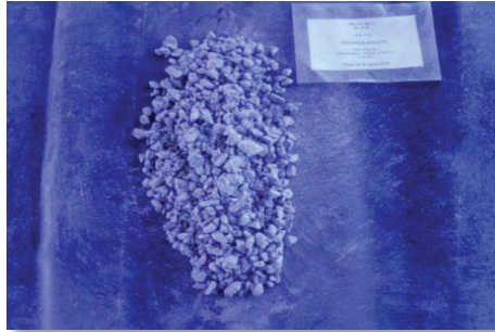
Figura 61 Aglomeración MA 4 Kg NaCl/TMS. 20 días. 10 Kg H 2 SO 4 /TMS, a 25°C y Presión atmosférica. [R s : 0,35]
