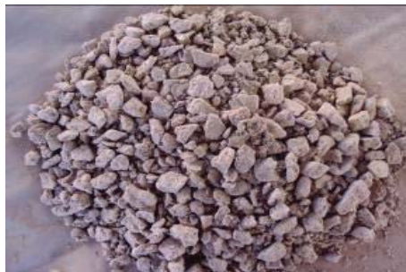
Figura 27 Aglomeración ARC 9 muestra 4 Kg NaCl/TMS. 10 Kg H 2 SO 4 /TMS, a 25°C y Presión atmosférica. [15 días]
