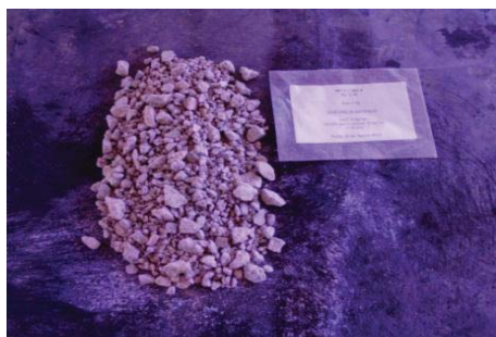
Figura 69 Aglomeración MA 4 Kg NaCl/TMS. 20 días. 10 Kg H 2 SO 4 /TMS, a 25°C y Presión atmosférica. [R s : 0,75]
