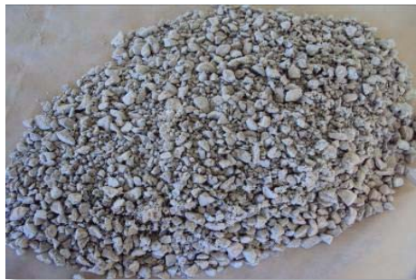
Figura 39 Aglomeración ARC 6 muestra 10 Kg NaCl/TMS. 10 Kg H_2SO_4 /TMS, a 25°C y Presión atmosférica. [10 días]
