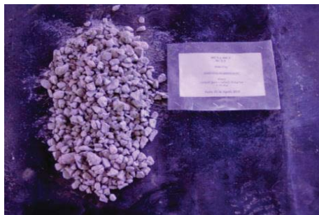
Figura 45 Aglomeración MA Blanco. 20 días. 10 Kg H 2 SO 4 /TMS, a 25°C y Presión atmosférica. [R s : 0,3]
