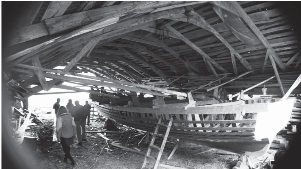
Figura 146. Interior donde construyen la embarcación. Las paredes del interior se utilizan para contener la construcción de la embarcación.
