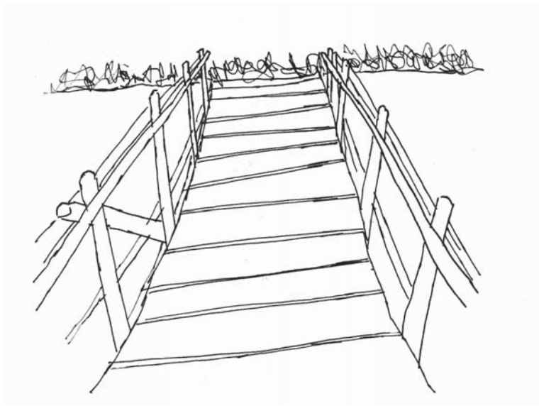
Figura 209. Dibujos basados en fotografías del montaje del puente pasarela. El suelo toma la forma curva de la cercha cambiando de nivel constantemente.
