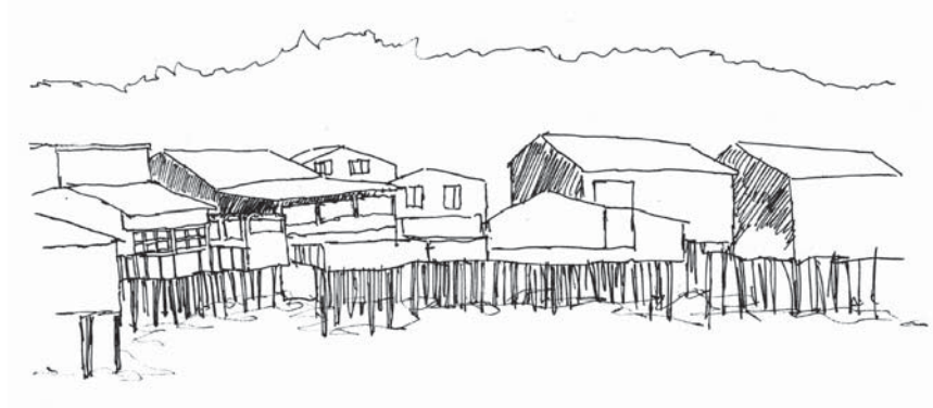
Figura 186. Croquis de un conjunto de casa chilotas basado en fotografía. La casa se levanta de la otorgando un rango a la superficie del agua para amortiguar el cambio de mareas. Esta condicionante es recogido por la estructura de la casa.
