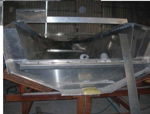
La ventaja de la aleación de aluminio utilizada (aleación aluminio magnesio, de la serie 5000) es que permite la soldadura y ésta tiene las mismas propiedades mecánicas del aluminio en sí. Por lo que una lancha se fabrica íntegramente por la unión del aluminio con la soldadura, sin el uso de remaches u otro tipo de uniones.
