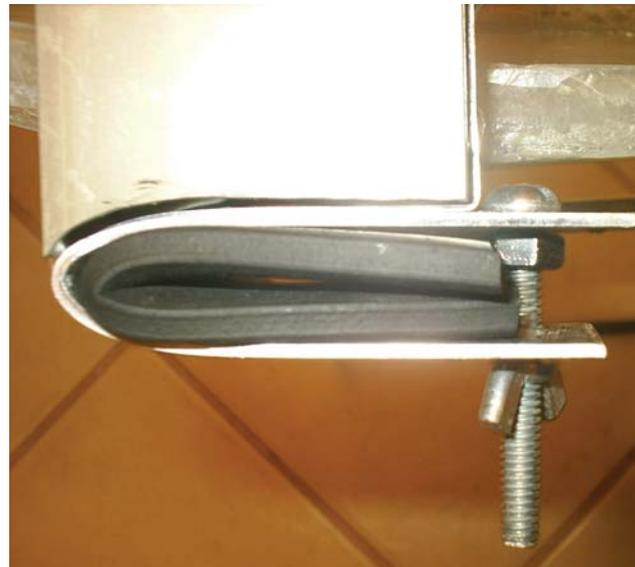
Una vez que las piezas de ajuste están unidas a la estructura de soporte, esta se sitúa sobre el casco del modelo sobre los puntos donde deben ir ubicados los perfiles sustentadores, de acuerdo a los cálculos de estabilidad. Cuando estas distancias se han verificado se remacha la estructura de soporte al borde estructural del casco.
