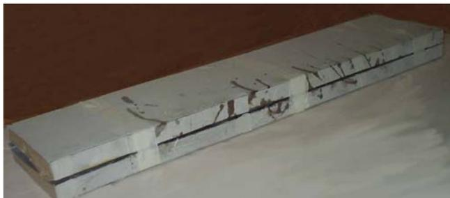
Cuando el perfil está completamente seco se desmolda de la matriz y los excesos de fibra son cortados. Para reparar las imperfecciones que puedan quedar se utiliza masilla mágica, luego es lijado y pulido. Se pinta para evitar cualquier tipo de filtraciones y comprobar que la superficie del perfil esté completamente lisa.
