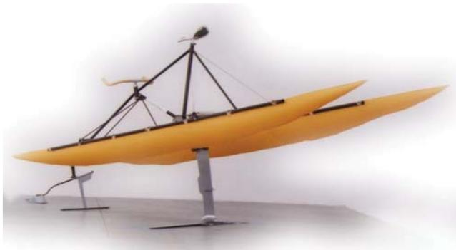
Recientemente se han diseñado unas que funcionan sin hélices. El Pumpabike es uno de los modelos con sistemas mecánico de propulsión. El usuario se impulsa mediante saltos, produciendo un movimiento oscilatorio que transmite la energía a la superficie del agua, deslizándose fácil y eficientemente. El diseño portátil, construido en plástico y aluminio, pesa 14 kilos y 2.2 metros de largo. Desarrolla entre 5 y 30 Kph.
