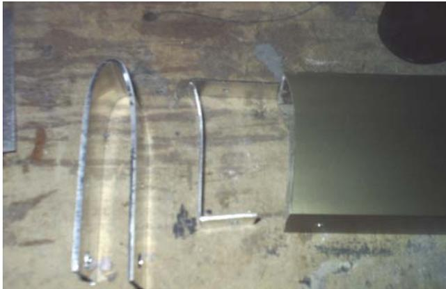
Se usa otra pletina que será la conexión entre la pieza que recibe el perfil alar y la estructura de soporte del modelo. Esta pieza sigue la curva de la forma de la pieza de unión con el perfil alar y se acopla con el sacado que se hizo. La pieza se perfora para poder ser remachada a la estructura de soporte y a la pieza que recibe el perfil.
