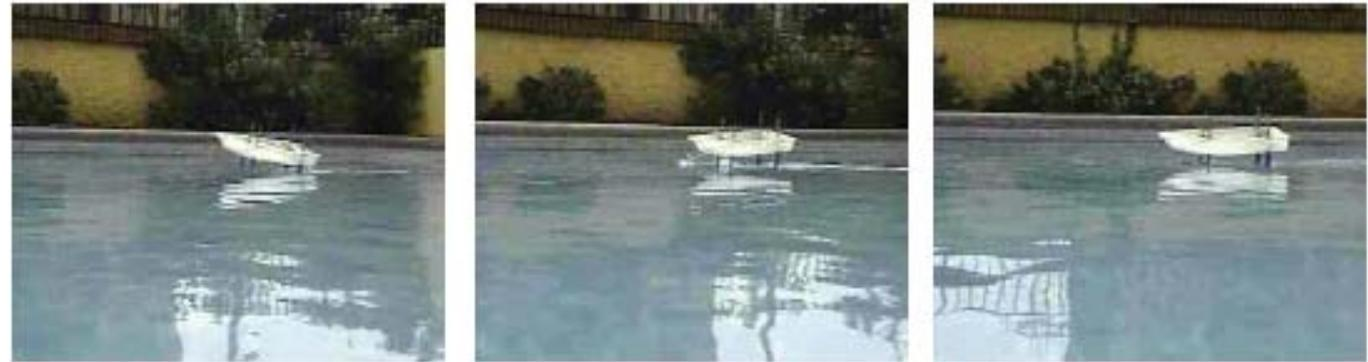
Al momento del despegue con las alas de doble curvatura se observa que el modelo despegue casi inmediatamente y a poca velocidad, alcanzando inmediatamente su altura límite.
