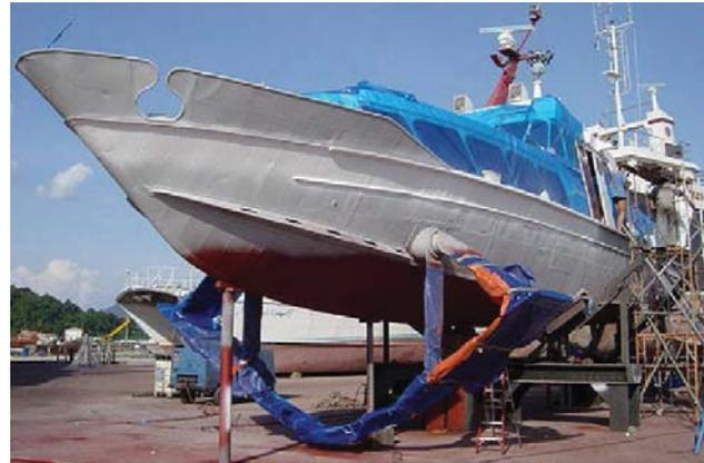
Tipo de casco utilizado en embarcaciones con hidroalas.
