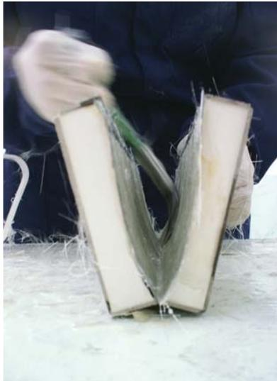
Luego se sella la matriz y se deja secar por aproximadamente 24 horas. En los perfiles verticales, se agrega una lámina de aluminio de un milímetro de espesor, debido al reducido tamaño de los perfiles, para que soporte mejor las torsiones y pueda conectarse con el perfil sustentador de modo más segura.
