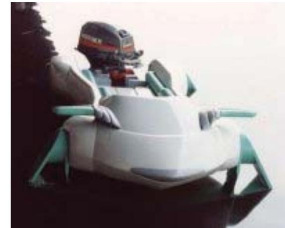
Dynafoil es una embarcación para dos personas, usa un motor integrado de 25 hp., pesa 350 lbs. y puede alcanzar 30 mph.
