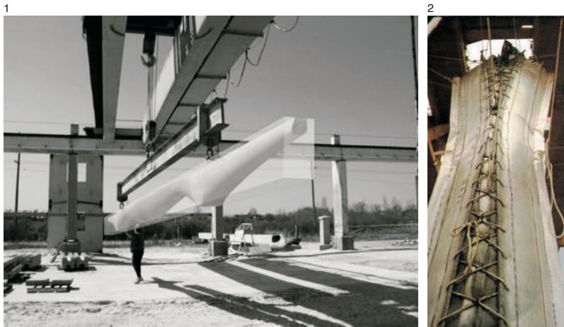
1. Relación virtual que muestra la diferencia de hormigón empleado asociado a la masa de una viga y a su sollicitación de fuerza. 2. Moldaje a partir de un textil reforzado con costuras, estas costuras generan impresiones en el fluido.
