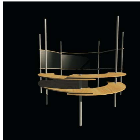
1. Stand proyectado para la intemperie, los parantes se estacan en la arena y funcionan como tensores de la tela.
