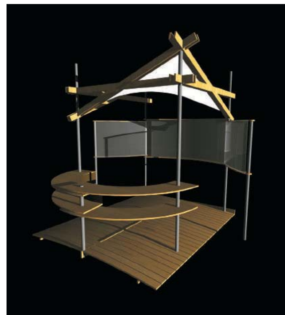
2. Stand proyectado para exposición de proyectos con incidencia marítima FEMAR, incorporación de suelo y cielo para muestra en interior.
