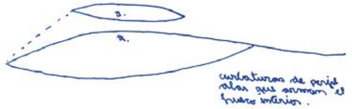
Las curvas del techo corresponden a secciones de perfil alar que generan el hueco interior
