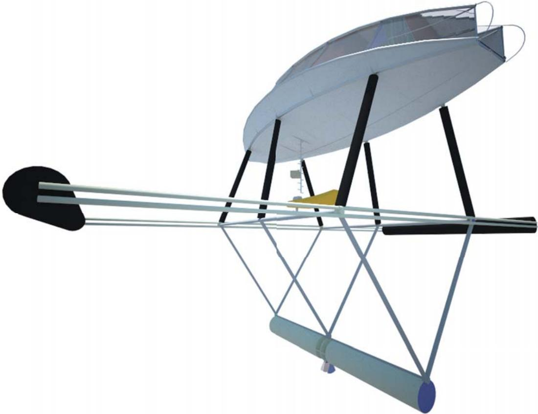
Estructura desplegada sin membrana envolvente.
